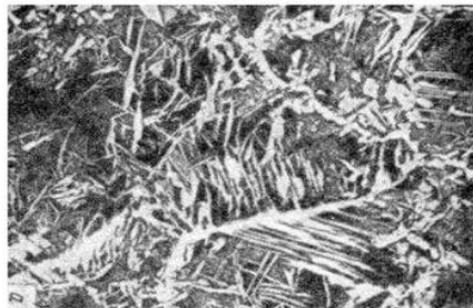
Пластинчатый (а) и зернистый (б) перлит, \times 500
