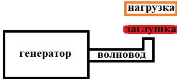
Режим работы линии характеризует **коэффициент бегущей волны**,  $K_{БВ} = E_{\text{мин}} / E_{\text{макс}}$ ,
