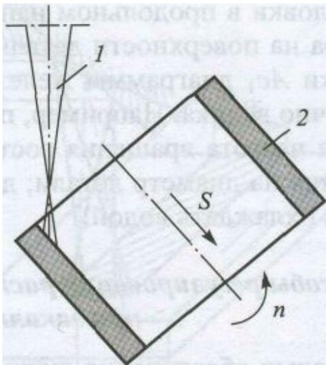
Рис.4.46. Схема упрочнения внутренней цилиндрической поверхности:
