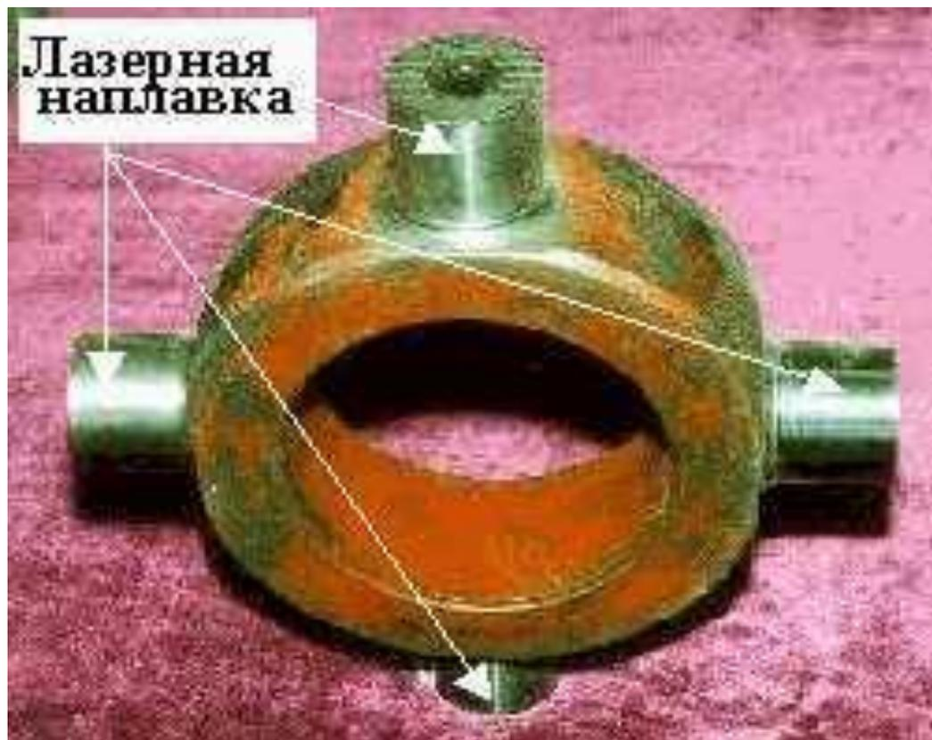
Восстановление изношенных крестовин локомотивов железнодорожного транспорта методом лазерной наплавки.
