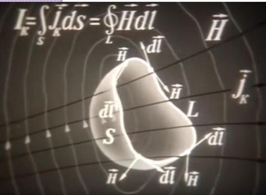
опытным путем он установил ток пронизывающий поверхность  $S$  равен циркуляции вектора напряженности магнитного поля по контуру  $L$ . Чтобы вычислить циркуляцию надо в каждой точки контура вектор напряженности поля скалярно умножить на векторный элемент дуги  $d\vec{l}$  и проинтегрировать по контуру.
