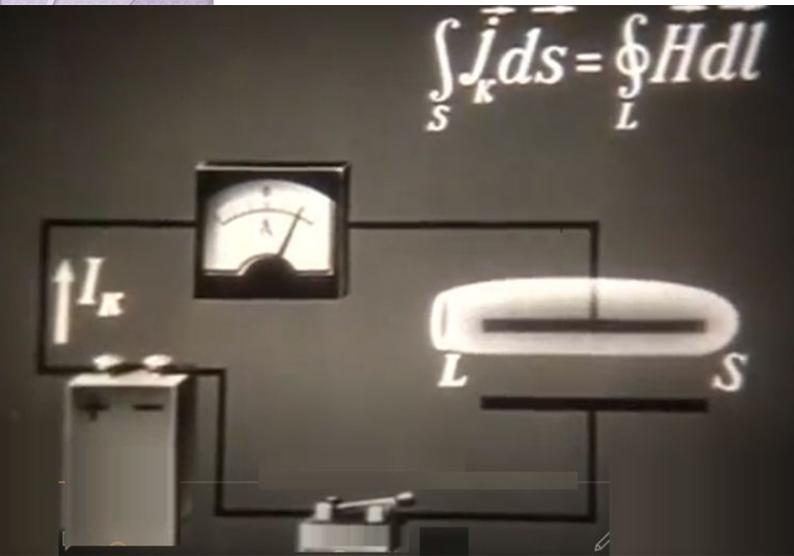
если уменьшать контур  $L$  стягивая в точку, циркуляция вектора магнитного поля будет стремиться к нулю, между тем амперметр в цепи конденсатора показывает, что ток втекает внутрь поверхность  $S$ , таким образом интегралы не равны друг другу
