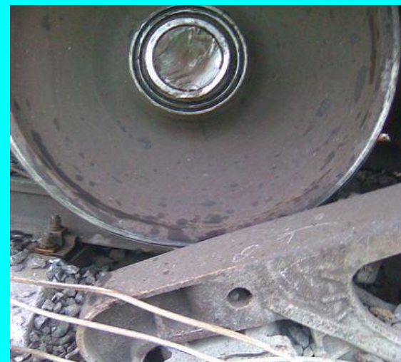
Усталостный излом шейки оси, КБШ ЖД, 2009 г.
