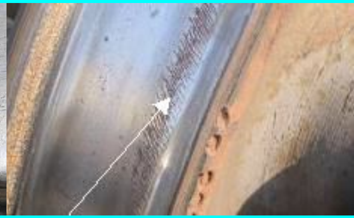
Трещины термической усталости
