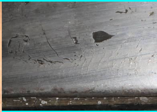
Трещины термической усталости
