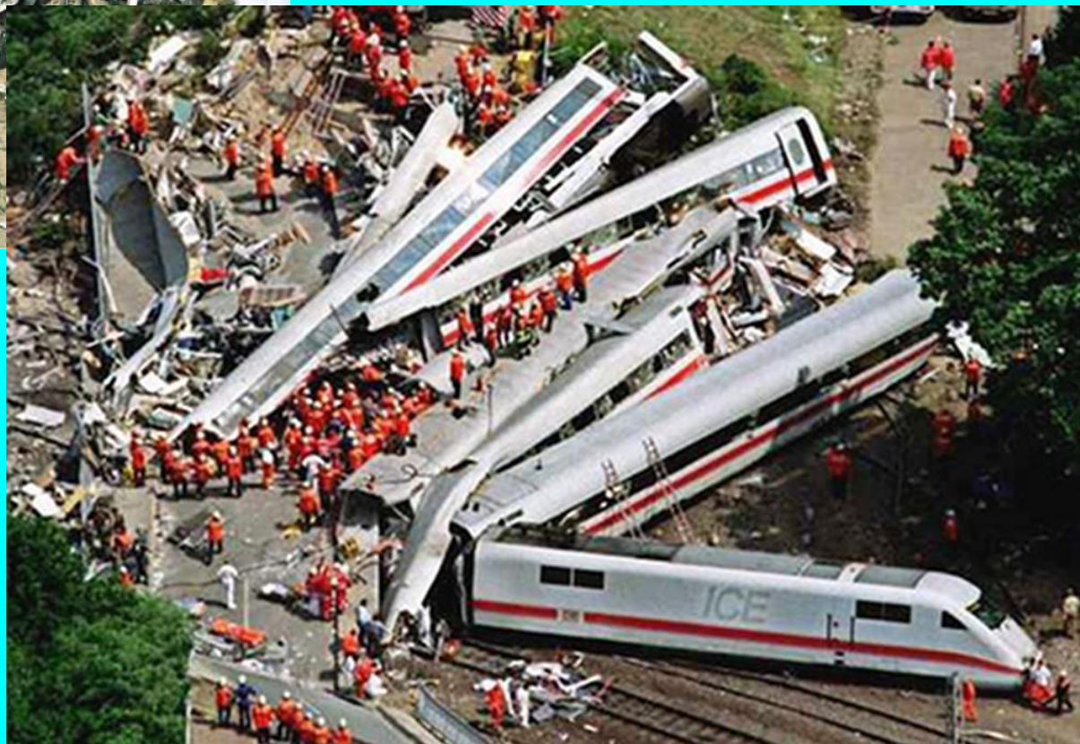
Крушение скоростного поезда ICE-1, 04.06.1998 г. по причине усталостного излома бандажа
