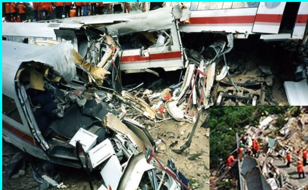
Крушение скоростного поезда ICE-1, 04.06.1998 г. по причине усталостного излома бандажа
