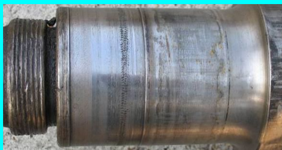
Износ шейки оси
