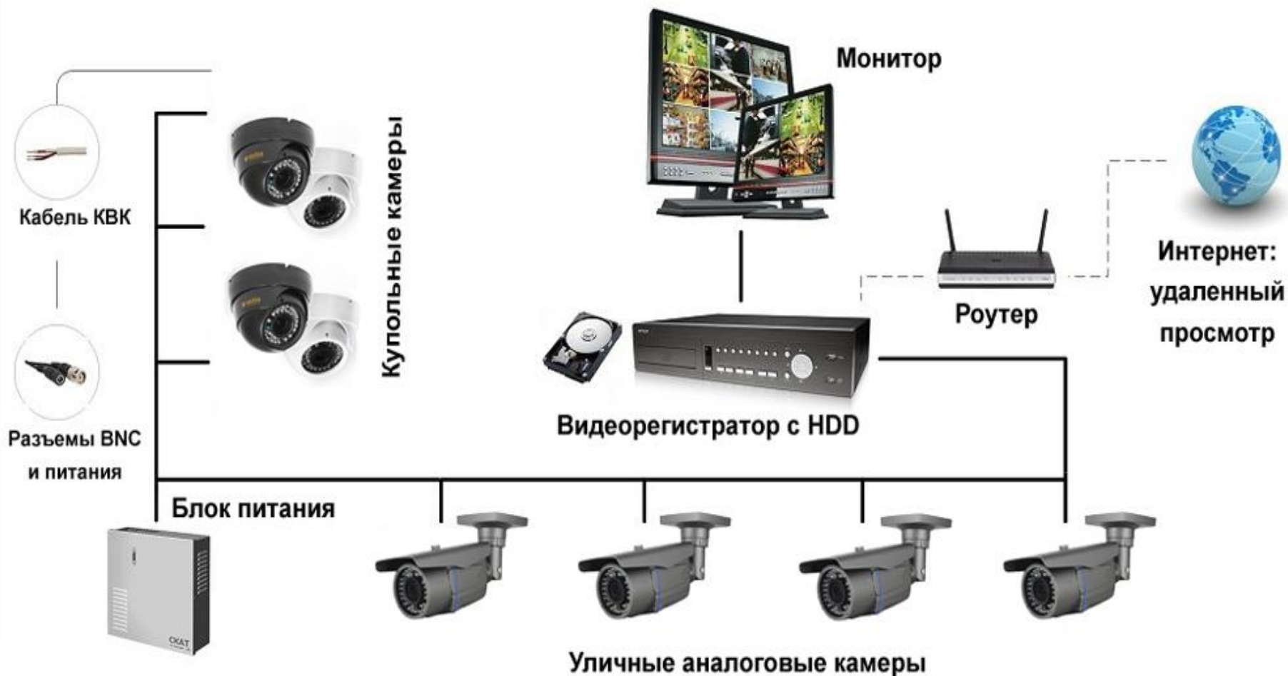
Типовая схема построения системы аналогового видеонаблюдения
