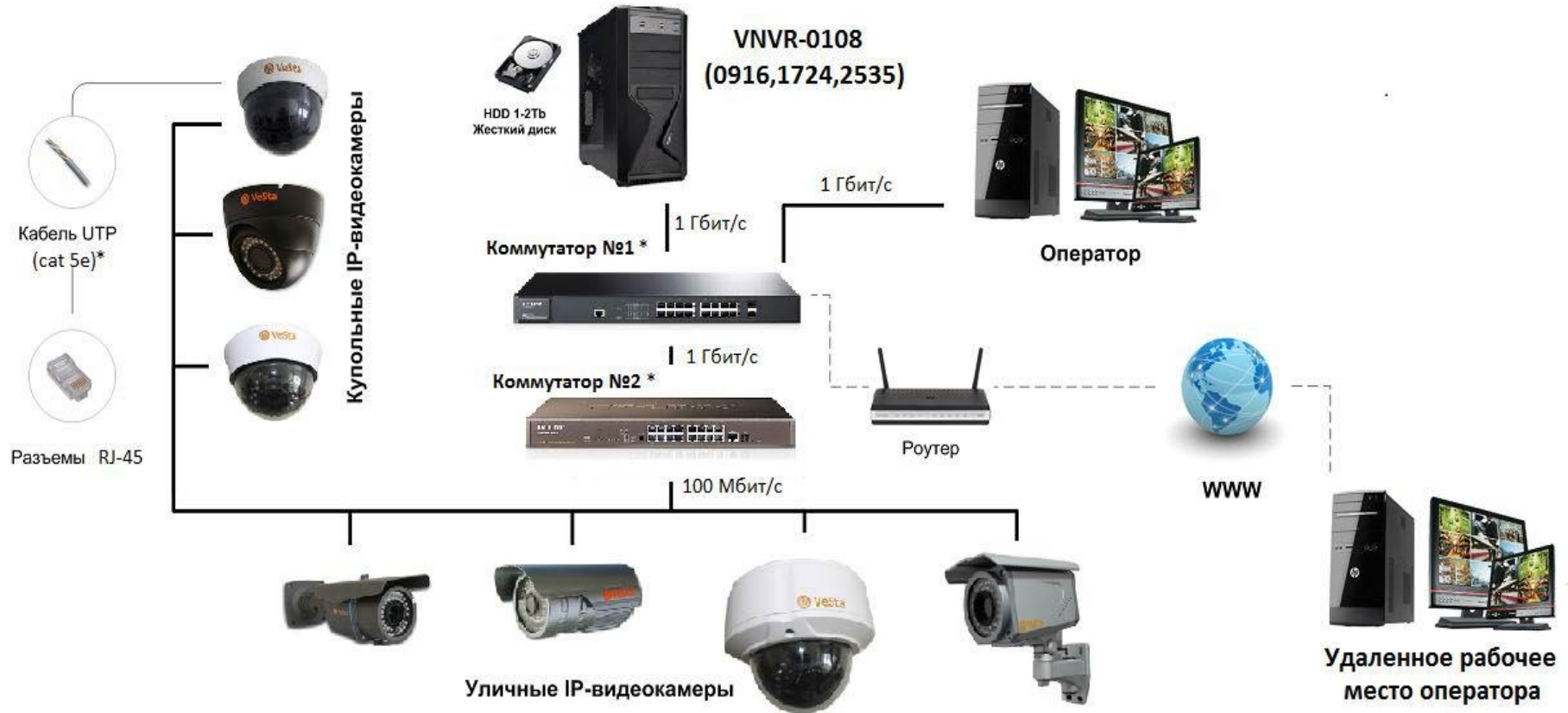
Типовая схема построения IP-видеонаблюдения VeSta
