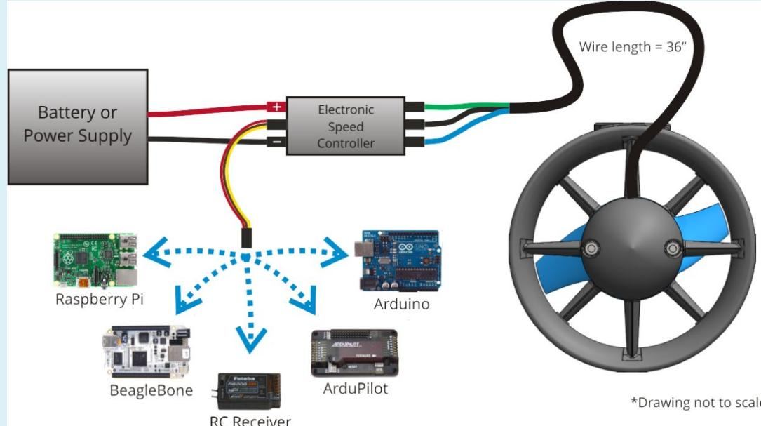
**Электронный регулятор хода** ([англ. ESC, Electronic Speed Controller](#)) — устройство для управления оборотами [электродвигателя](#), применяемое на радиоуправляемых моделях с электрической силовой установкой.
