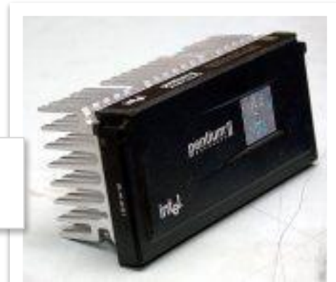
Pentium-II, Celeron 1997 - 2000 7,5 млн. транзисторов частоты до 500 МГц
