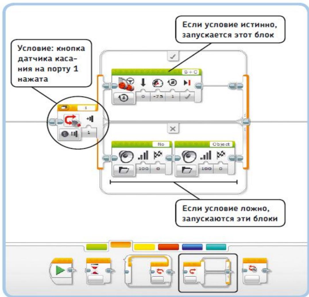
Рис. 6.12. Блок Переключатель проверяет, является ли условие истинным или ложным, и запускает соответствующие блоки. Вы указываете состояние, нужный режим и параметры на блоке Переключатель
