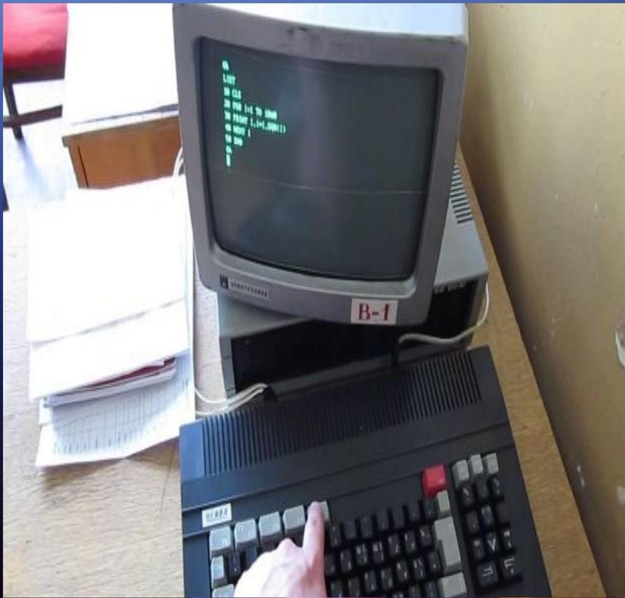
«Корвет» разрабатывали для рабочих потребностей: он мог обрабатывать информацию, делать расчеты, составлять архивы данных. Персональный компьютер был одной из передовых разработок СССР и отображал графику на высокой скорости. Разработчики даже утверждали, что этот параметр был лучшим по сравнению с IBM PC. Но из-за большого количества брака, допущенного при производстве, «Корвет» не стал популярным и славился своей ненадежностью.
