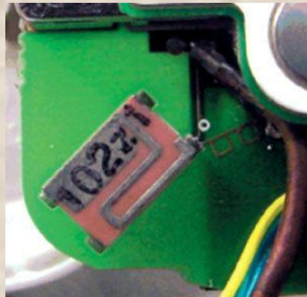
**Рис.21 - Внутренняя Bluetooth-антенна**
