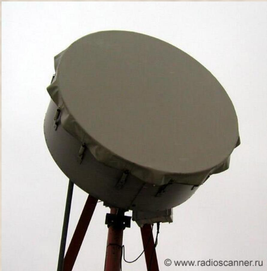
**Рис.41 - Антенна РРС *Ericsson MiniLink*. Зеркало большого диаметра.**
