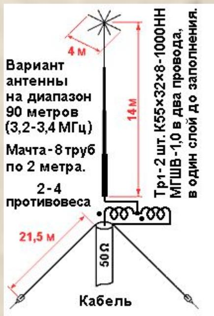
Рис.4 – КВ антенна на вещательные КВ диапазоны 75, 49, 31, 25 метров
