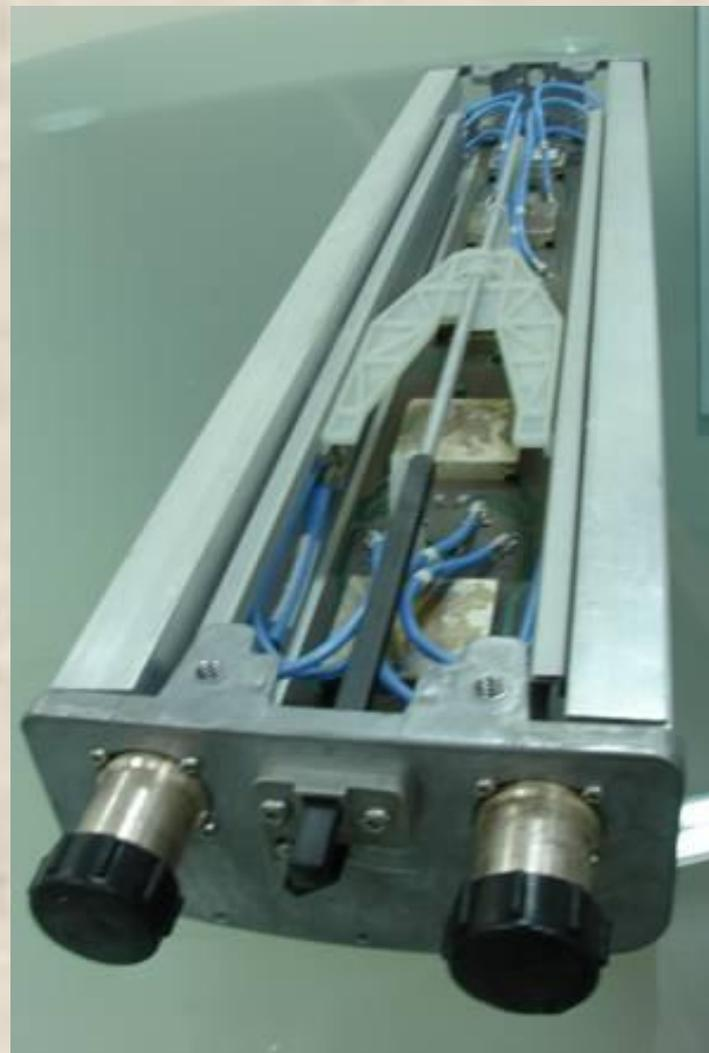
**Рис.16 - Система запитки антенны *Powerwave 7600.06* диапазона 1710 – 1880 МГц, выполненная в виде единой печатной платы (фото слева) и система запитки антенны *Powerwave 7720.00* диапазона 1710 – 2170 МГц, с регулируемым углом электрического наклона (фото справа)**
