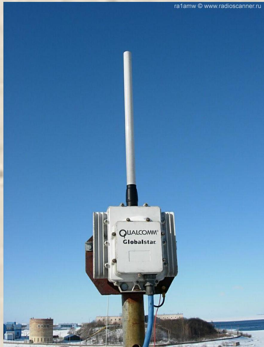
**Рис.29 -Спутниковая антенна Qualcomm Globalstar на пароме «Георг Отс»**
