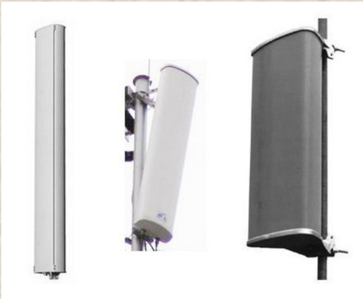
**Рис.13 – антенны базовых станций: слева направо: универсальная антенна Kathrein 739 623 (900 МГц, 2 метра в высоту, луч 65°), универсальная антенна Allgon 7330.00 Dualband (900/1800 МГц, 1,5 метра, луч 65°), трассовая антенна Kathrein K73 45 647 (900 МГц, 2,5 метра, луч 36°)**
