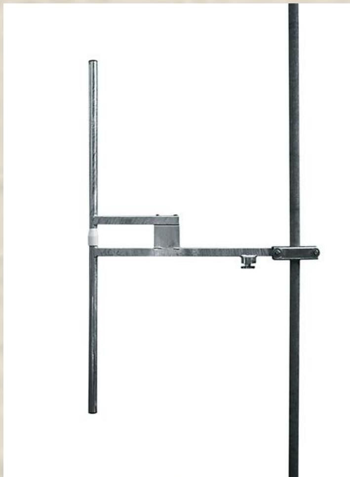
**Рис.12 - Высококачественные дипольные передающие антенны FM диапазона 87,5-108МГц PLS1, DIP11, DIP15 предназначены для построения антенных систем различных диаграмм направленности. Внешняя конструкция антенн DIP11, DIP15 выполнена из гальванизированной стали, PLS1 из алюминия. Внутренние элементы из посеребренной меди и фторопласта. Все проводящие элементы заземлены по постоянному току**
