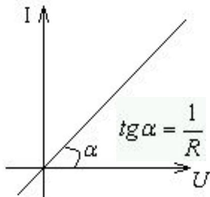
Между напряжением  $U$  и силой тока  $I$  в проводнике существует функциональная зависимость  $I=f(U)$ , называемая **вольтамперной характеристикой (ВАХ)**.
