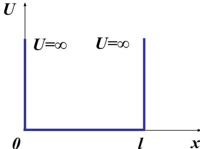
Одномерный случай: частица движется только вдоль оси  $x$ .
