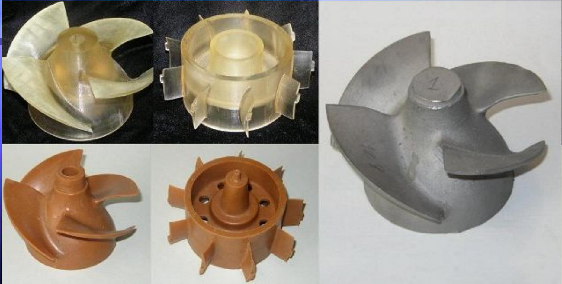
Пластиковые стереолитографические модели рабочих колес для водометных движителей, изготовленные по ним восковые модели («восковки») и готовая металлическая отливка
