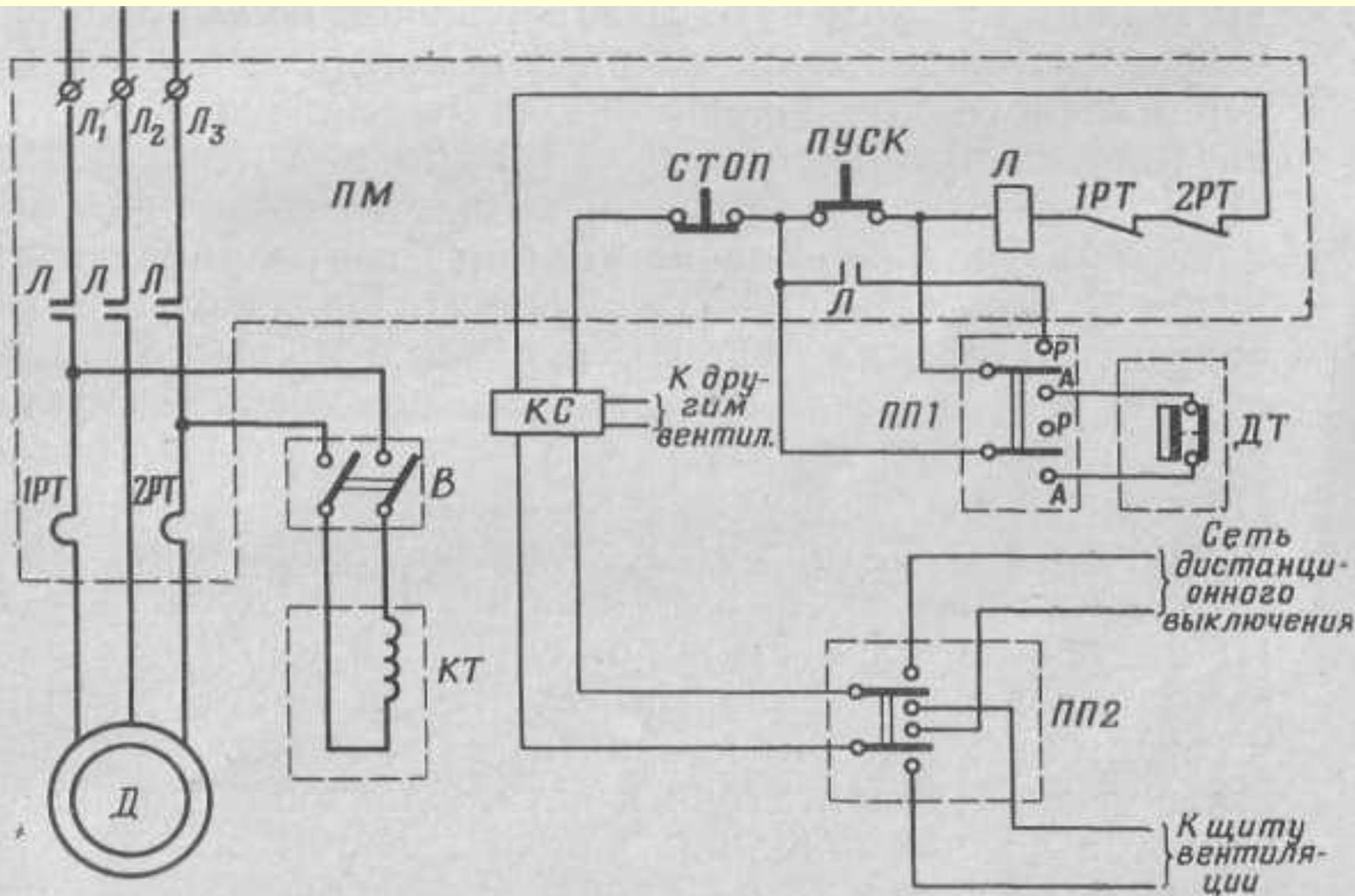
Рис. 94. Элементная схема управления автоматизированным электроприводом вентилятора
