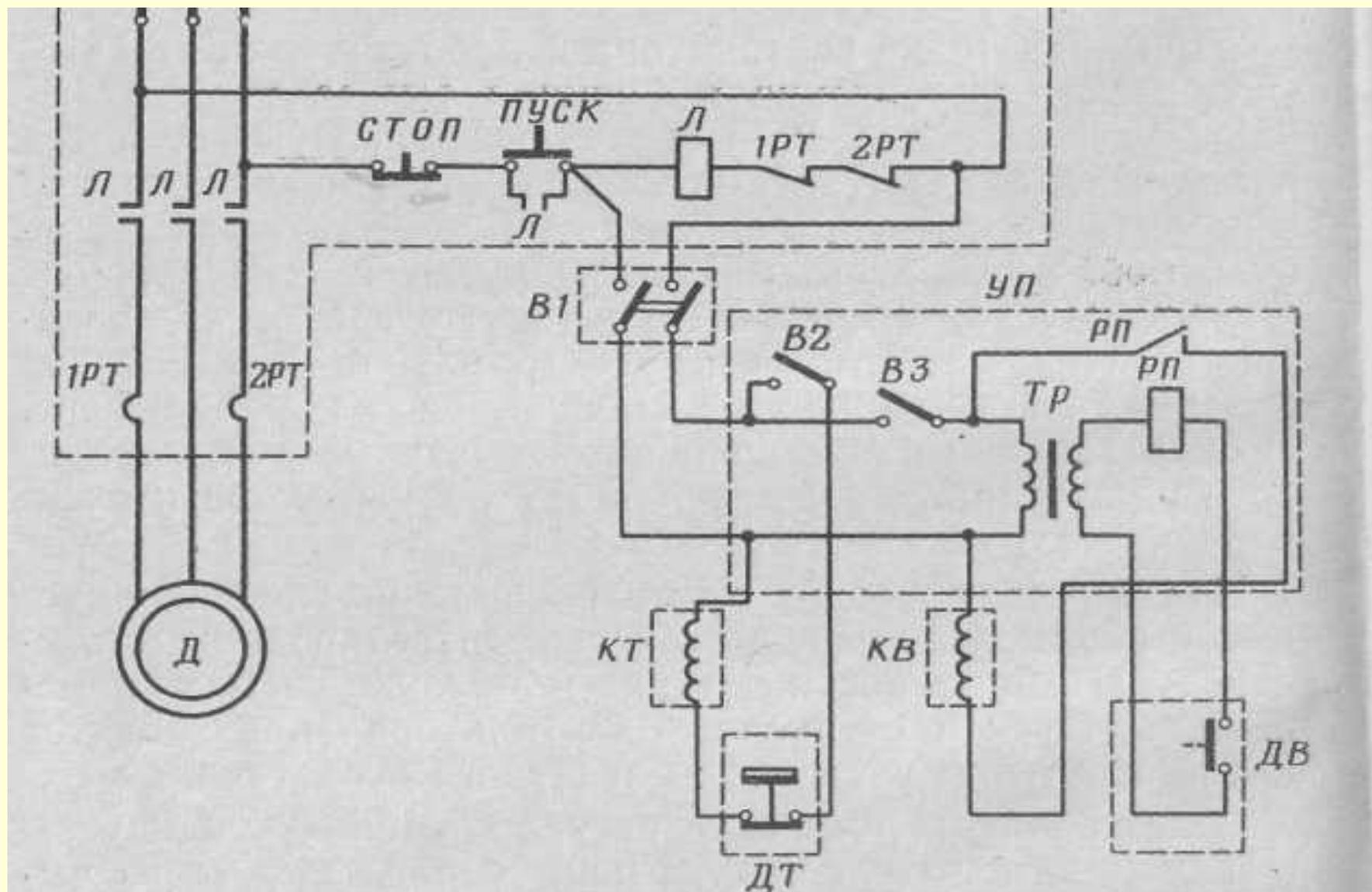
Рис. 95. Элементная схема управления электроприводом вентилятора с автоматическим регулированием температуры и влажности
