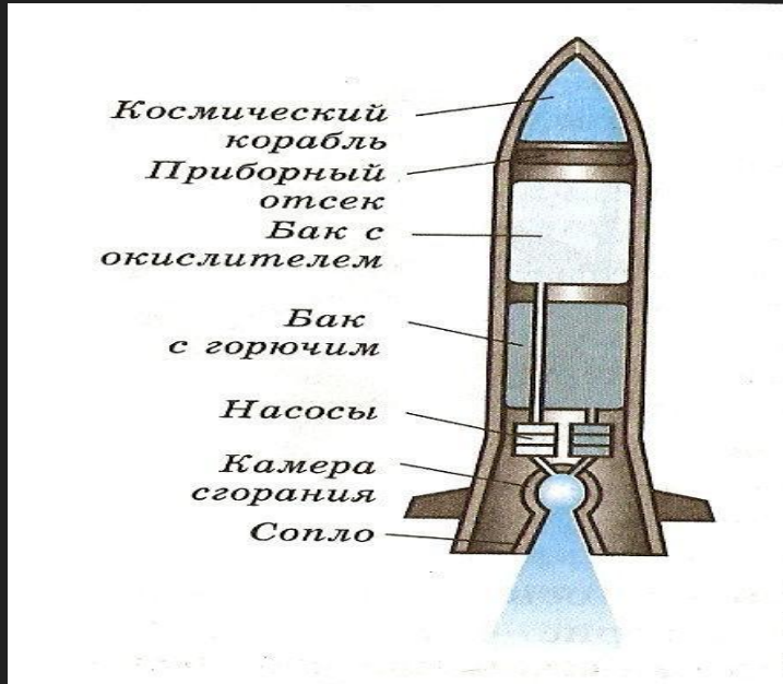
Устройство одноступенчатой ракеты
