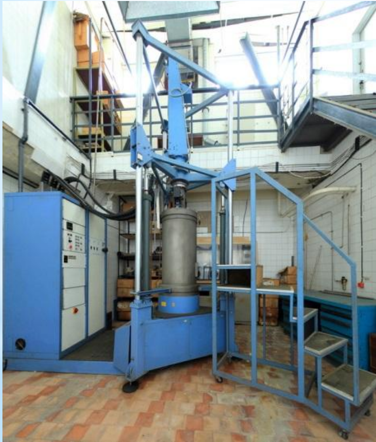
Установка SG15/25 с 3-мя зонами выращивания кристаллов, автоматизированными процессами
