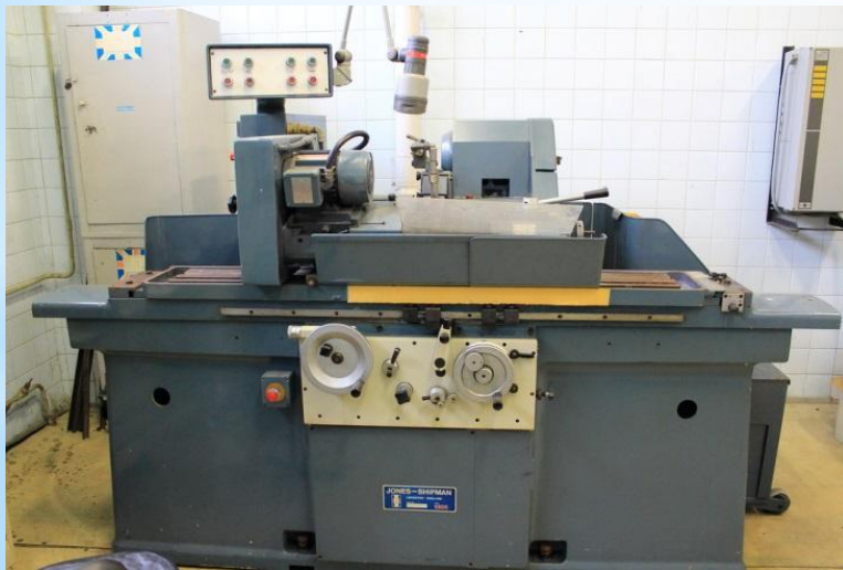
Установка для калибровки слитков, Jones-Shipman 1305.
