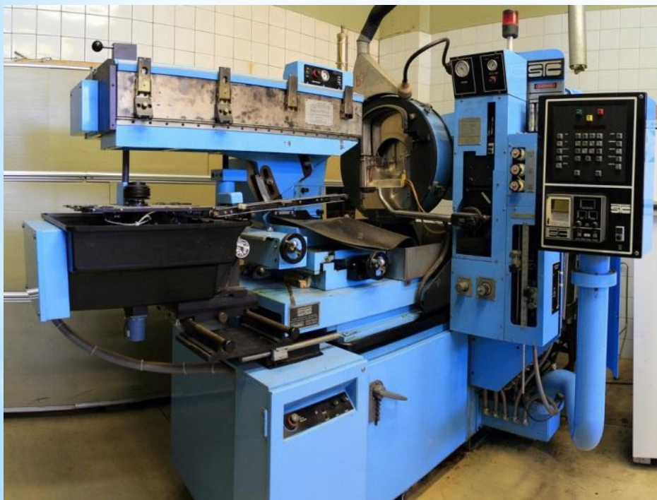
Установки для резки слитков/ростовых затравок STC-155 и Mikroslice-4
