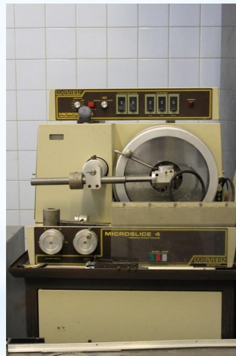
Установки для резки слитков/ростовых затравок STC-155 и Mikroslice-4
