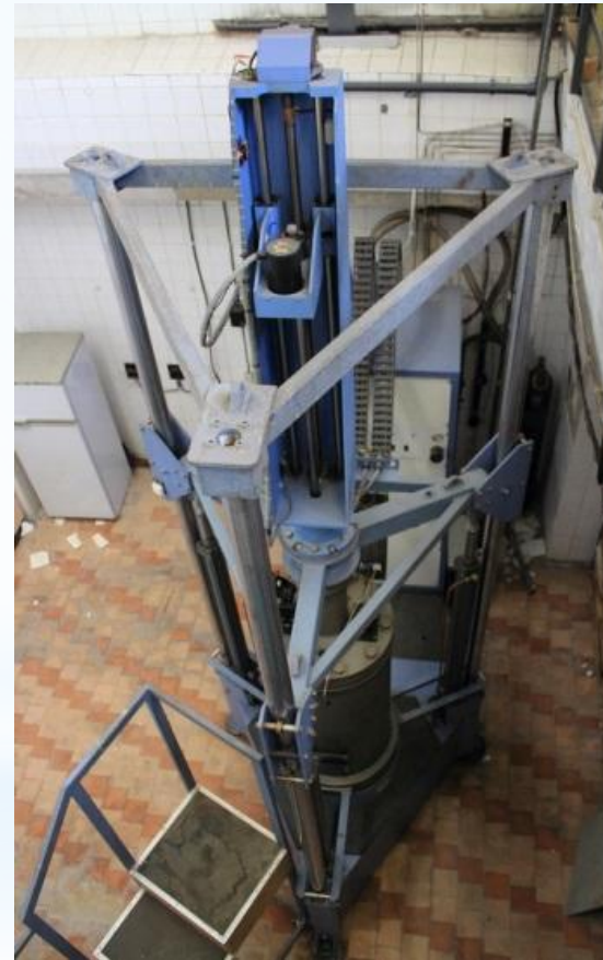
Установка SG15/25 с 3-мя зонами выращивания кристаллов, автоматизированными процессами
