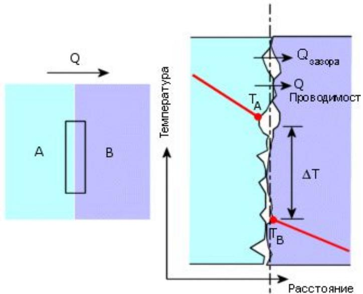
Для сборок дополнительно необходимо определять условия термического контакта. Это связано с наличием у поверхности после механической обработки шероховатости, отклонений от правильной формы и положения. Из-за этого две поверхности никогда не могут образовать абсолютный контакт.
