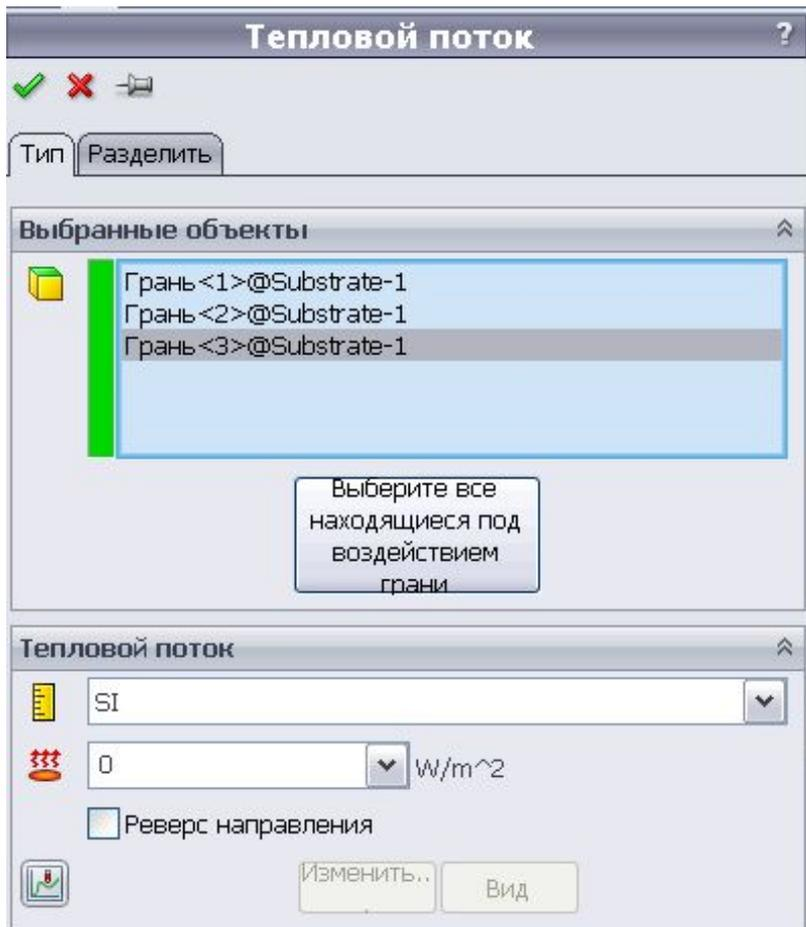
Ограничение Тепловой поток позволяет применить его к выбранными поверхностями. Тепловой поток используется только в термических исследований.
