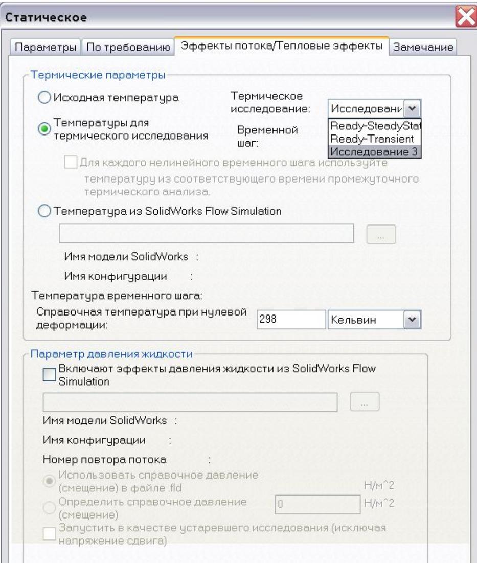
Анализ термических напряжений относится к статическому анализу, который включает в себя воздействие температуры.
