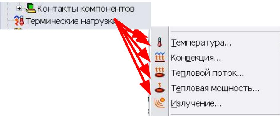
Термические нагрузки и ограничения, за исключением температуры, которая может быть использована в других исследованиях конструкций, доступны только для термических исследований.
