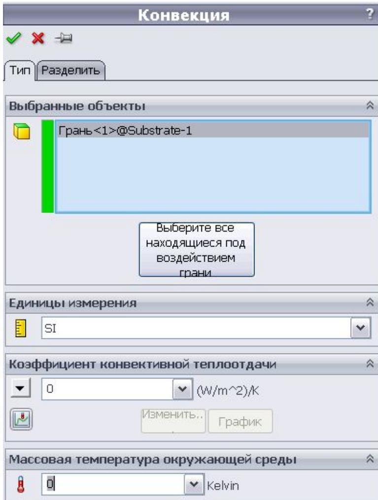
Опция Конвекция используется для задания граничных условий конвекции к выбранным граням модели в термическом анализе (устойчивого состояния и переходного).
