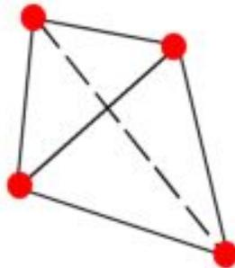
Параболический тетраэдральный элемент представляет собой четыре угловых узла, шесть средних узлов и шесть кромок.
