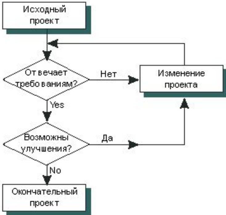
Проектирование – это многошаговый (итерационный) процесс, при котором конструкция постоянно меняется, пока не станет отвечать критериям качества, таким как прочность, себестоимость, эксплуатационные, эстетические характеристики и др.
