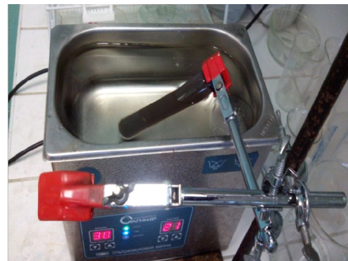
Фото разбиения частиц компонентов суспензии при помощи ультразвука
