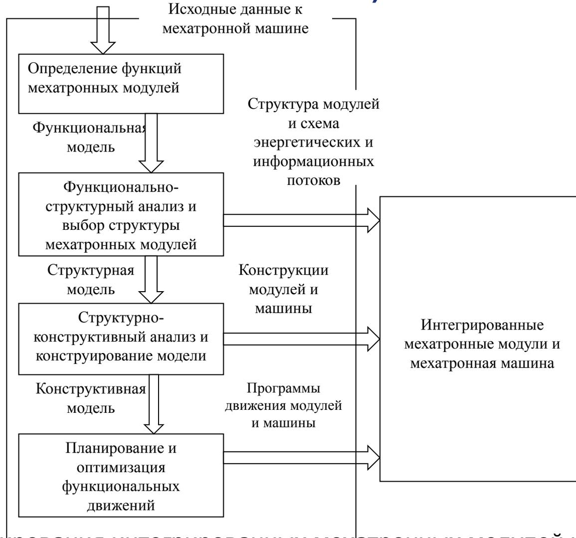
Процедура проектирования интегрированных мехатронных модулей и машин
