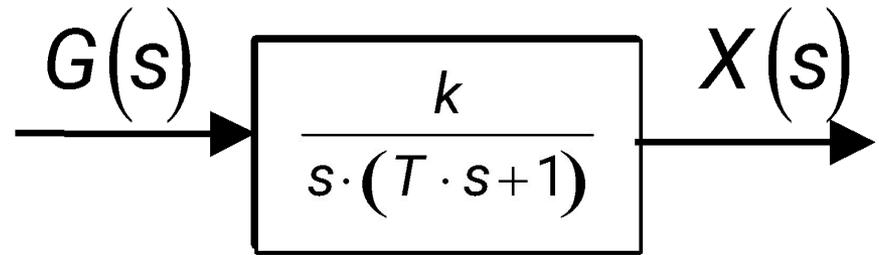
*Решение.* Передаточную функцию разомкнутой системы  $W(s)$  можно представить в виде последовательного соединения элементарных звеньев:
