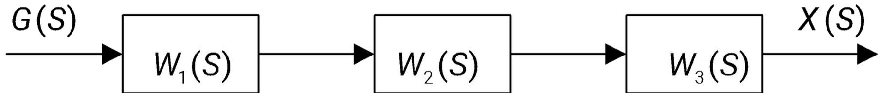
1. Интегрирующего звена с передаточной функцией  $W_1(s) = \frac{1}{s}$ .
