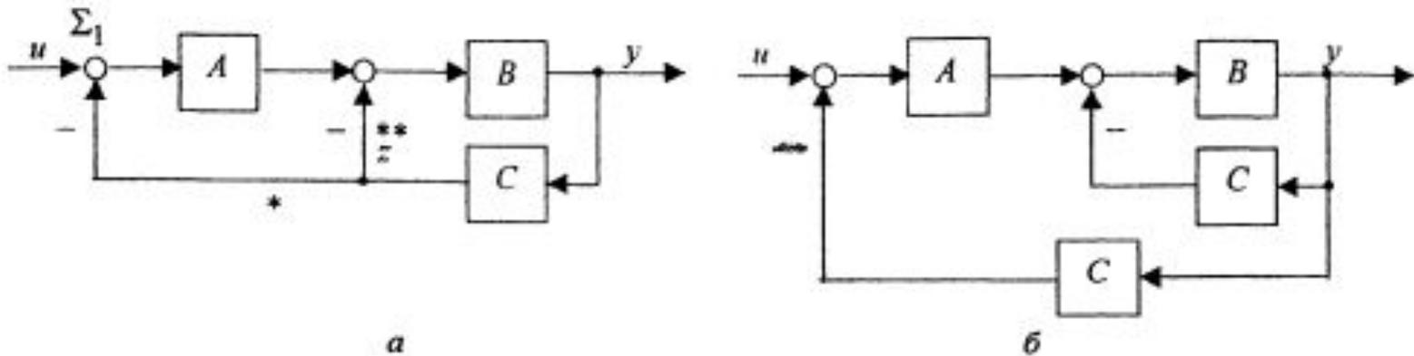
Пример структурного преобразование: а - исходная схема; б - эквивалентная схема
