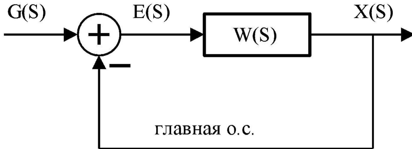
К такой структурной схеме (расчётной схеме) можно привести любую систему автоматического управления с помощью правил зования структурных схем.
