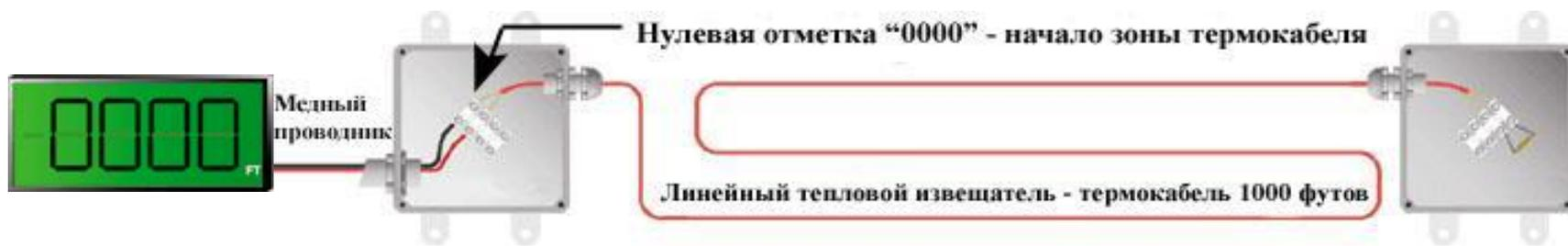
После проведения монтажных работ каждая зона термокабеля калибруется, для исключения сопротивления медного проводника при считывании длины измерителем. Для этого необходимо «закоротить» термокабель в начале зоны и измеритель настроится на нулевую отметку «0000».
