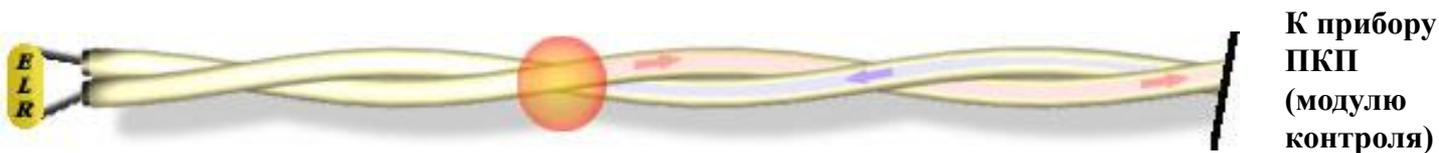
При достижении порогового значения температуры, под действием давления проводников, происходит разрушение изоляционного покрытия из теплочувствительного полимера, позволяя проводникам войти в контакт друг с другом. При этом резко возрастает величина тока, проходящая по шлейфу прибор ПКП - термокабель - оконечный резистор, и цепь контроля переходит в состояние «тревоги».
