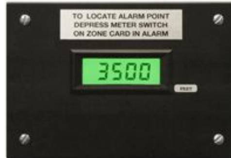
Измеритель расстояния до точки активации - это эксклюзивная разработка компании Protectowire, предназначенная для определения местонахождения точки активации по всей длине термокабеля. Измеритель выдает на дисплей расстояние в метрах от начала термокабеля до точки активации.
