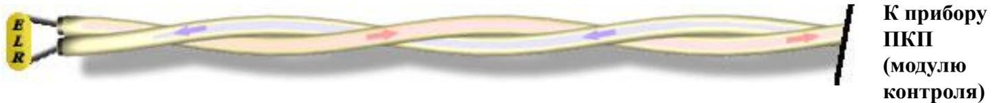
Термокабель подключается на входы (типа «сухой контакт») к любому устройству контроля. Через термокабель постоянно проходит контролирующий ток, величина которого ограничивается окончательным сопротивлением (ELR).
