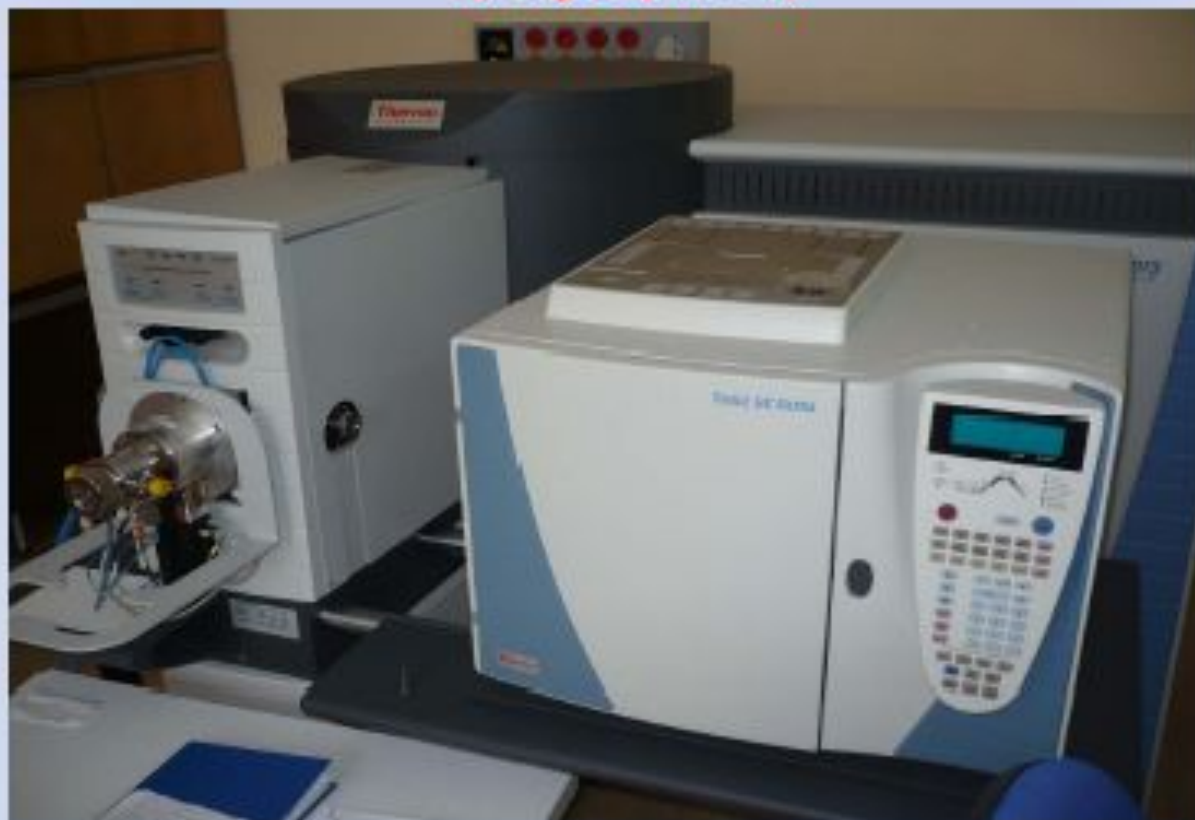
Масс-спектрометр высокого разрешения с хроматографической приставкой Thermo Electron DFS
