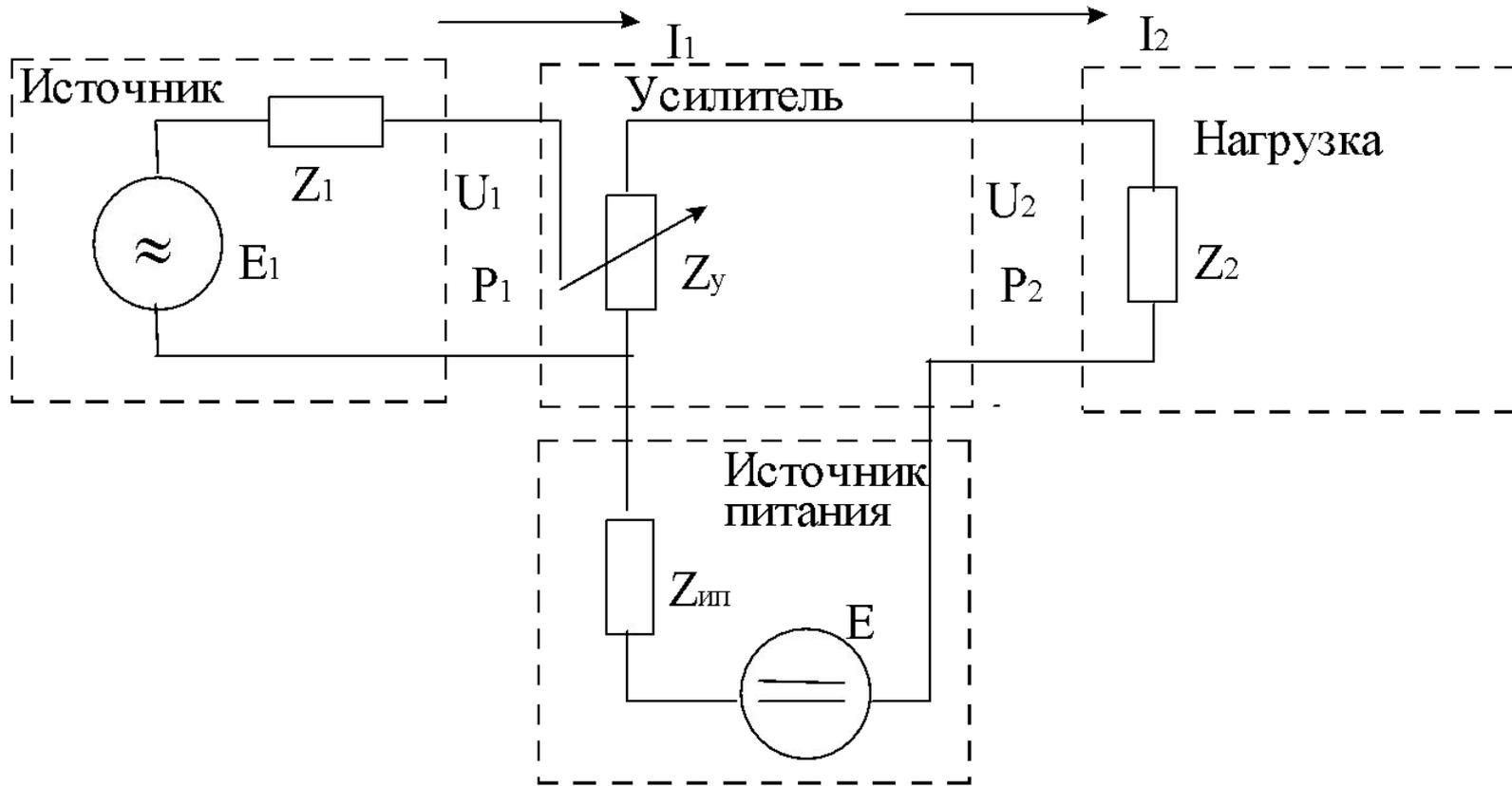
В усилителях, эквивалентная схема которого представлена на рисунке, источник управляющей энергии называется *источником сигнала*, а цепь усилителя, в которую поступают его электрические колебания, – *входом*.
