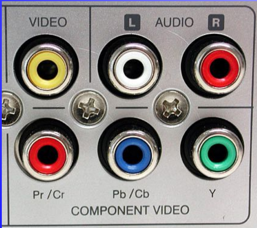
"Тюльпан" (Cinch/RCA): композитный видео, аудио, HDTV
