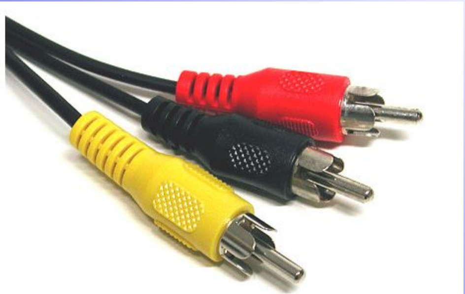
Вилки "тюльпан" имеют разное цветовое кодирование в зависимости от типа сигнала.
