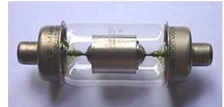
3.6. С газообразным диэлектриком – диэлектрики: воздух, элегаз, азот, фреон.
