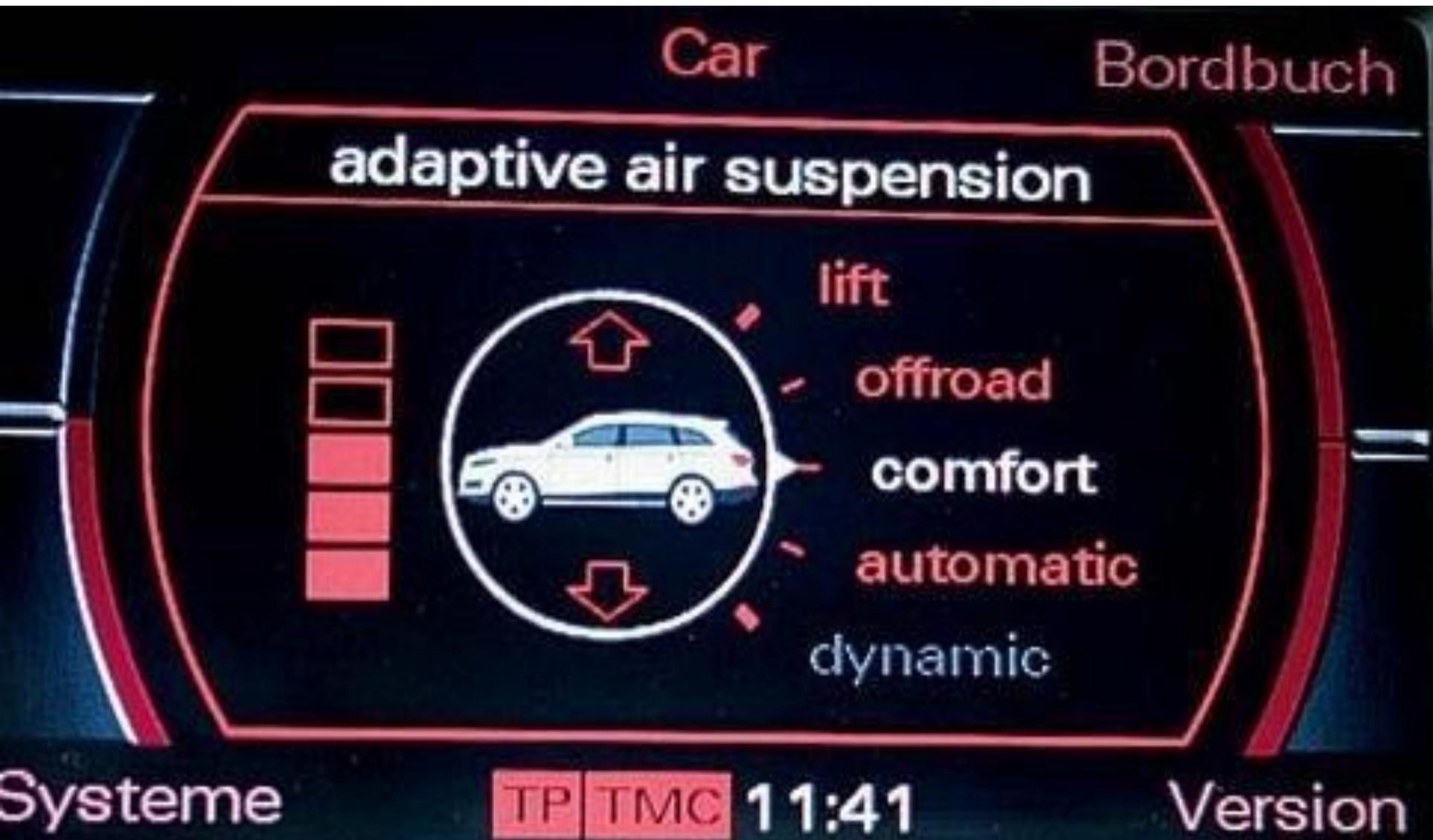
Эта система регулирования дорожного просвета, которая в отличие от своей предшественницы гидропневматической системы, полностью основывается на несущих пневмобаллонах, что позволяет регулировать дорожный просвет вне зависимости от степени загрузки автомобиля. Так же эта система позволяет адаптировать амортизирующее усилие и жесткость работы пневмостойки к любому дорожному покрытию
