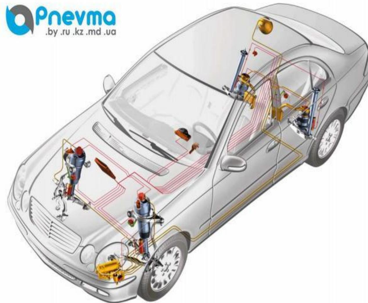
Пневматический упругий элемент составляет основу пневматической подвески. Он обеспечивает регулирование высоты кузова относительно поверхности дороги. Давление в пневматических упругих элементах создается с помощью пневматического привода, включающего электродвигатель с компрессором.
