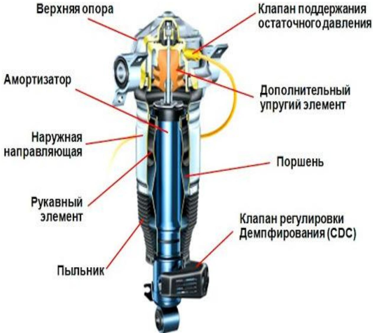
Сигналы от датчиков поступают в электронный блок управления, где в соответствии с заложенной программой происходит их обработка и формирование управляющих сигналов на исполнительные устройства — регулировочные электромагнитные клапаны
