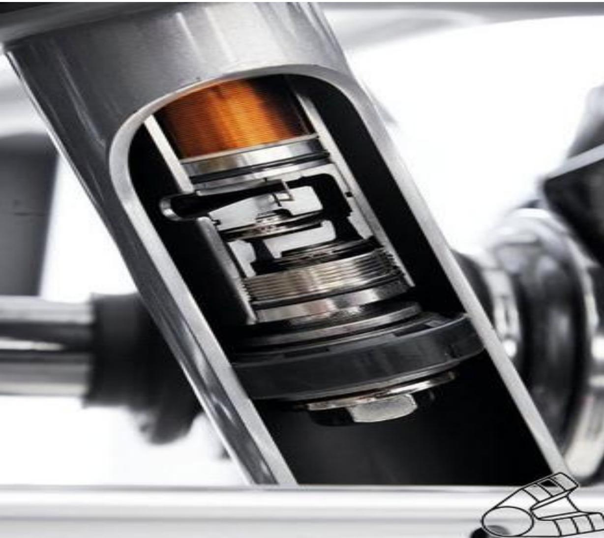
В современных конструкциях адаптивной подвески используется два способа регулирования степени демпфирования амортизаторов с помощью электромагнитных клапанов;
