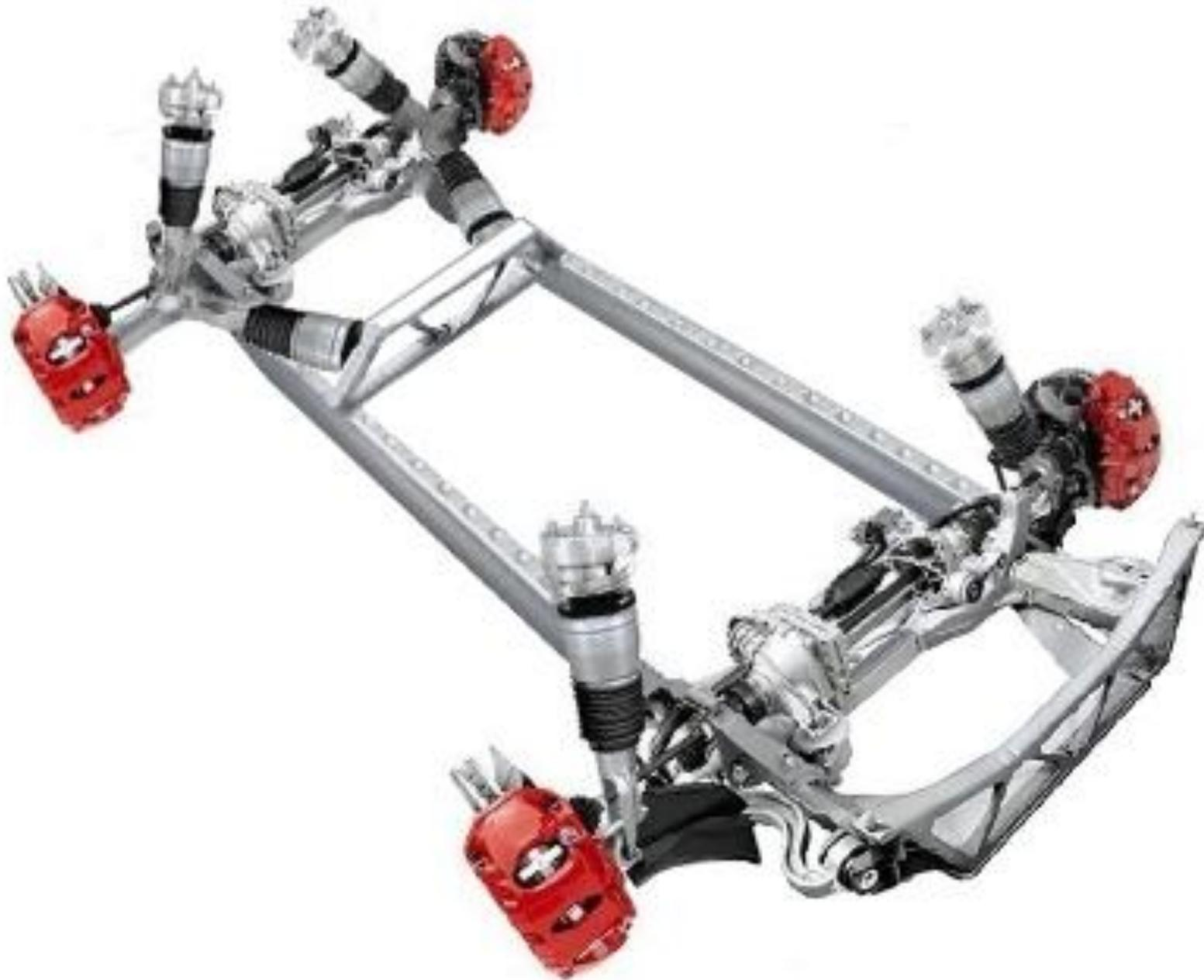
**Регулируемые подвески автомобиля.** Системы регулировки уровня пола кузова обычно устанавливаются на дорогие и большие модели для исключения возможности проседания загруженного автомобиля
