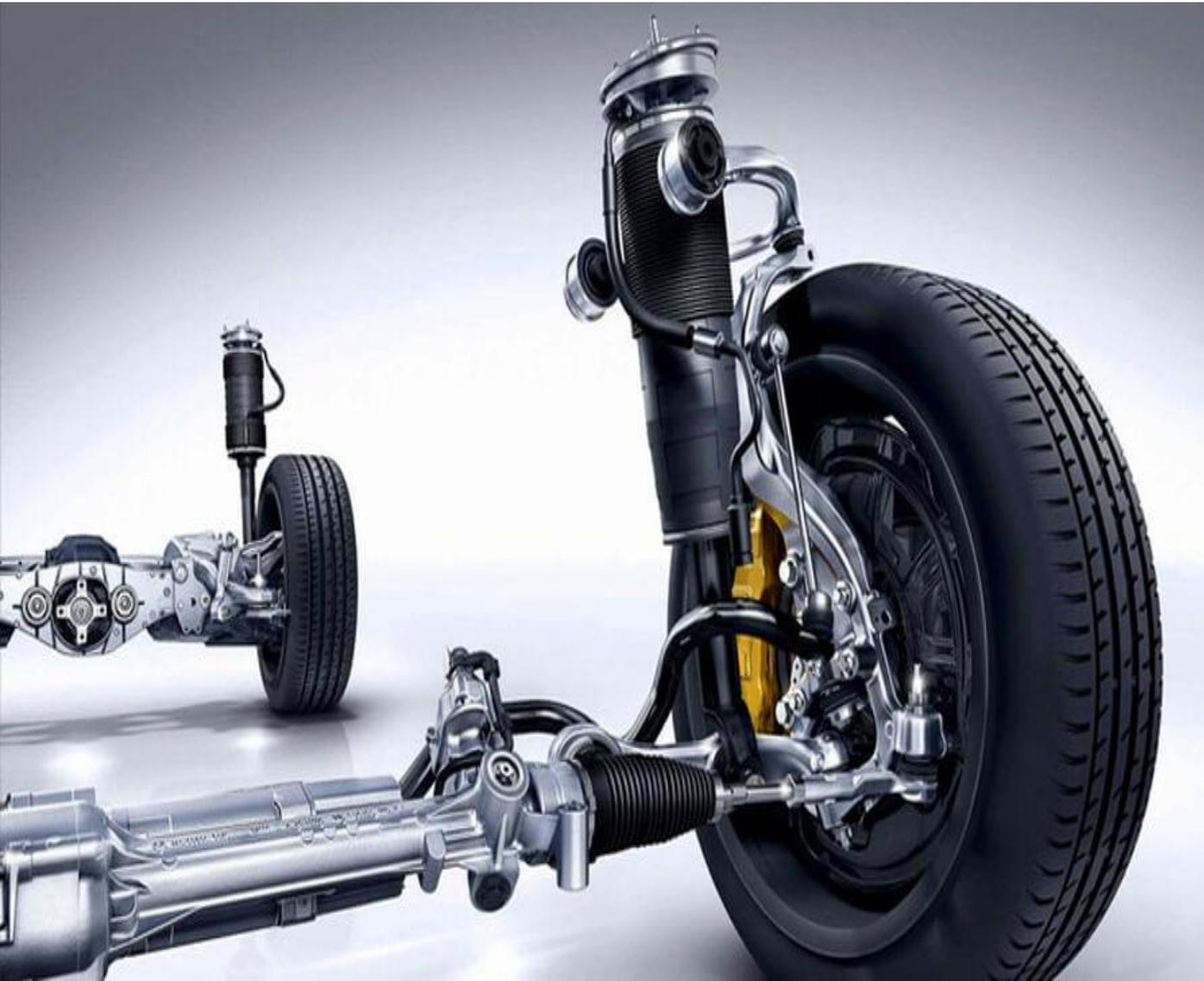
С помощью переключателя режимов работы производится настройка степени демпфирования адаптивной подвески.
