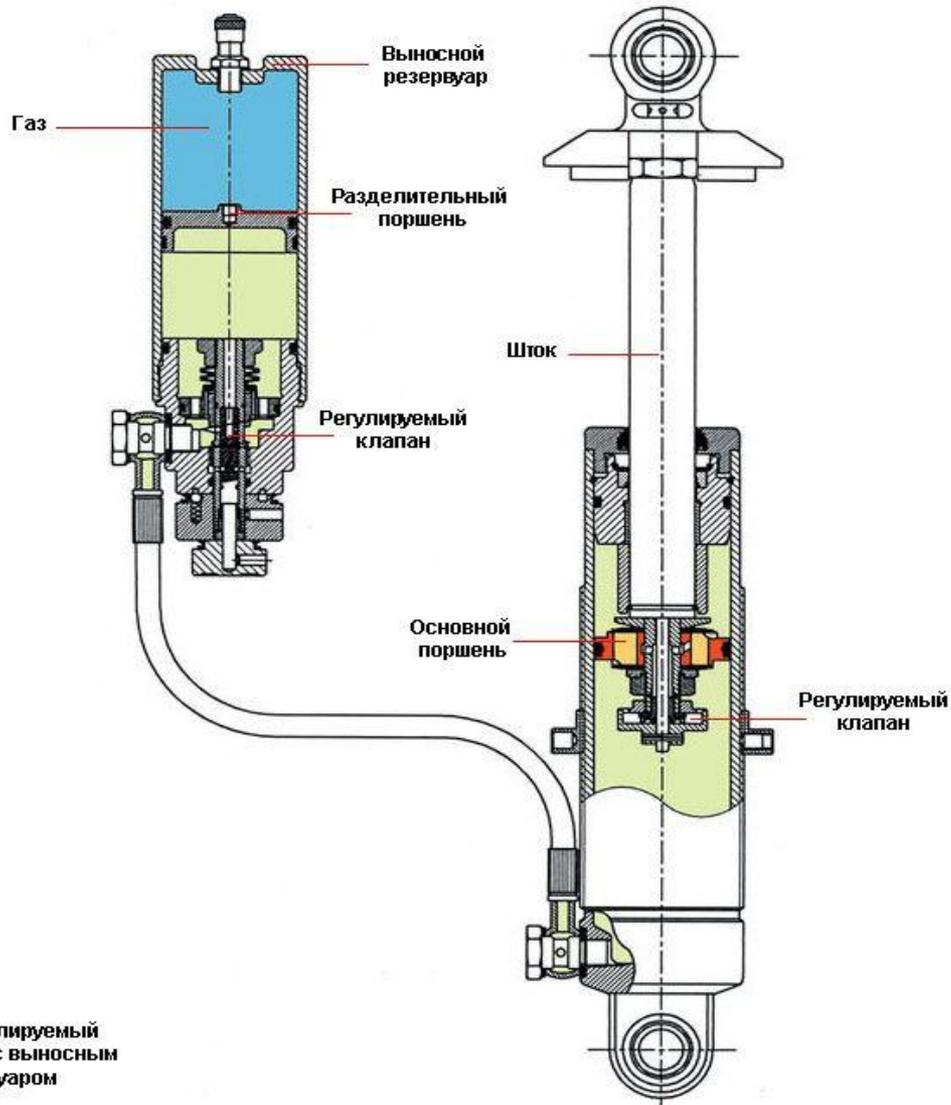
При регулировании с помощью электромагнитного регулировочного клапана изменяется его проходное сечение в зависимости от величины воздействующего тока.
