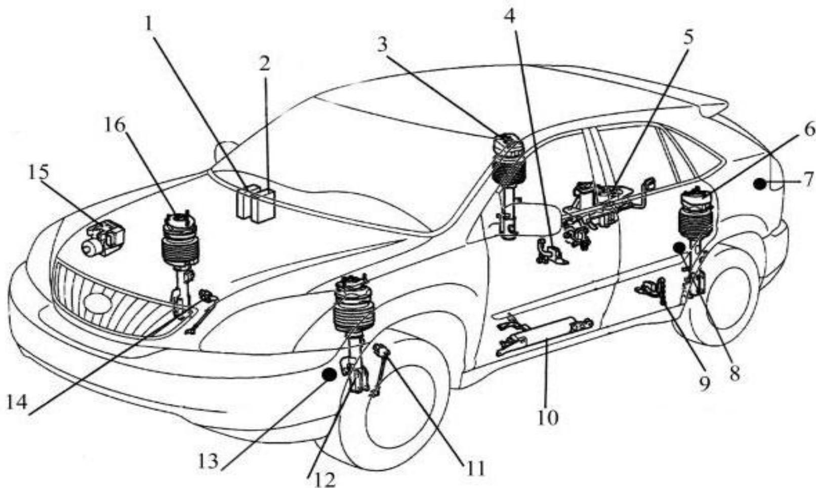
**Устройство пневматической подвески:** 1 – блок управления подвеской; 2 – блок управления двигателем; 3, 6 – задняя стойка с пневмоэлементом; 4 – правый задний датчик положения кузова; 5 – компрессор пневмоподвески; 7 – датчик ускорения кузова; 8, 13 – датчик ускорения колеса; 9 – левый задний датчик положения кузова; 10 – ресивер; 11 – левый передний датчик положения кузова; 12, 16 – передняя стойка с пневмоэлементом; 14 – правый передний датчик положения кузова; 15 – блок управления АБС.
