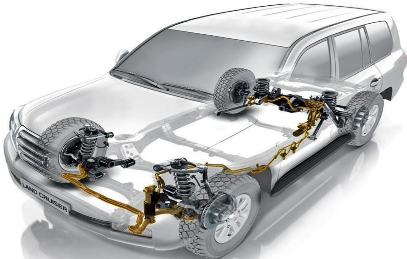
Подвеской автомобиля называется.....совокупность устройств, осуществляющих упругую связь колес с несущей системой автомобиля (рамой или кузовом)
