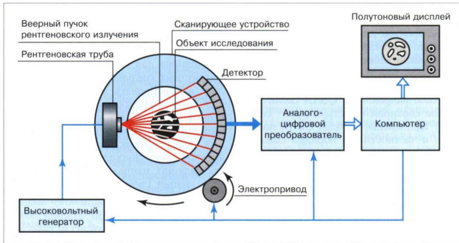
Рис. 1. Структурная схема рентгеновского компьютерного томографа.
