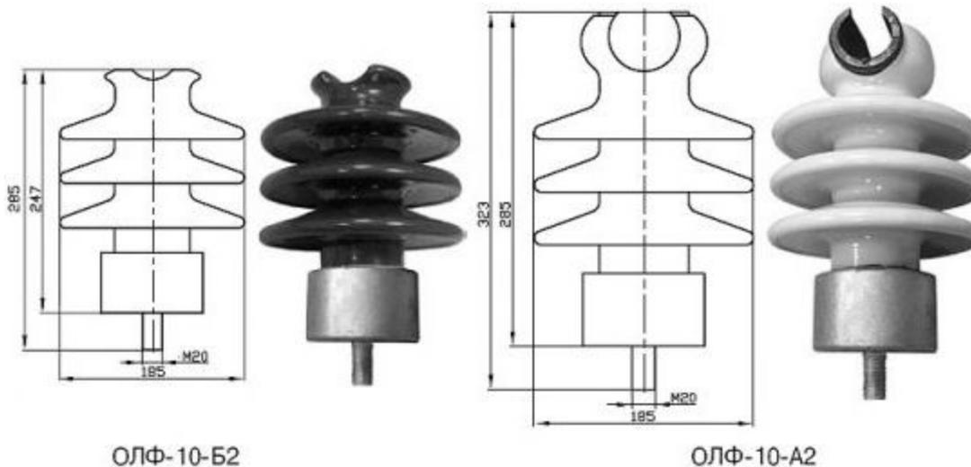
**Штыревые фарфоровые изоляторы серии ОЛФ-10 предназначены для крепления незащищенных (ОЛФ-10-Б2) и защищенных изоляцией проводов СИП-3 (ОЛФ-10-А2), на промежуточных, промежуточно-угловых и иных опорах напряжением 6 – 10 кВ.**
