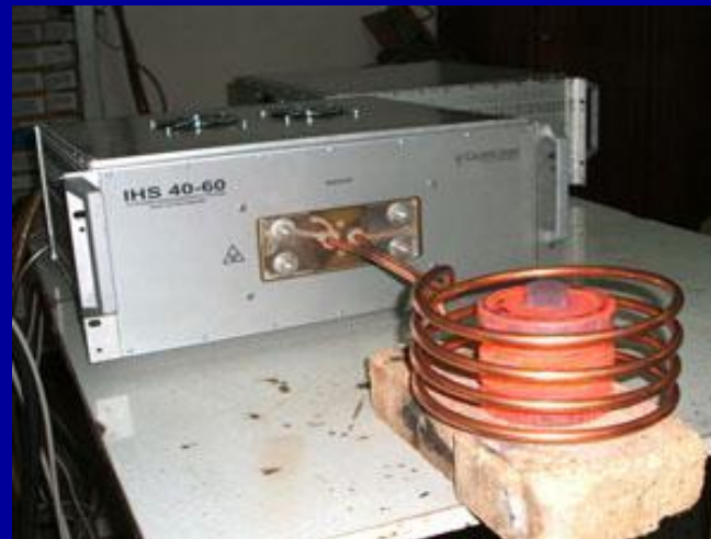
Установка индукционного нагрева на частоту 1000 Гц.
