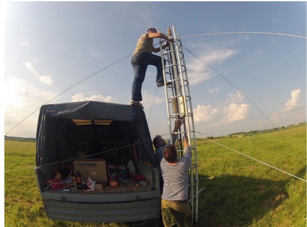
Установка на стартовое устройство
