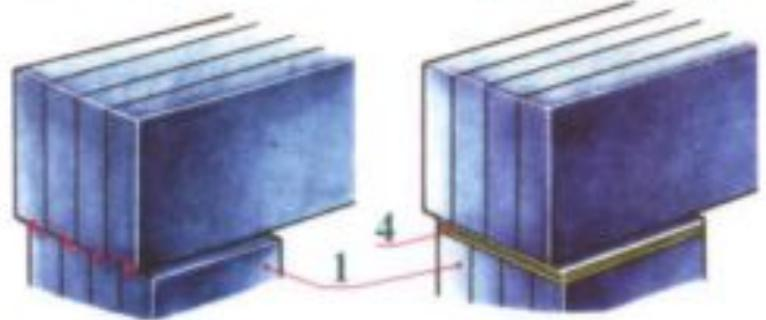
Сборка (шихтовка) пластин впереплёт с прямым стыкованием
