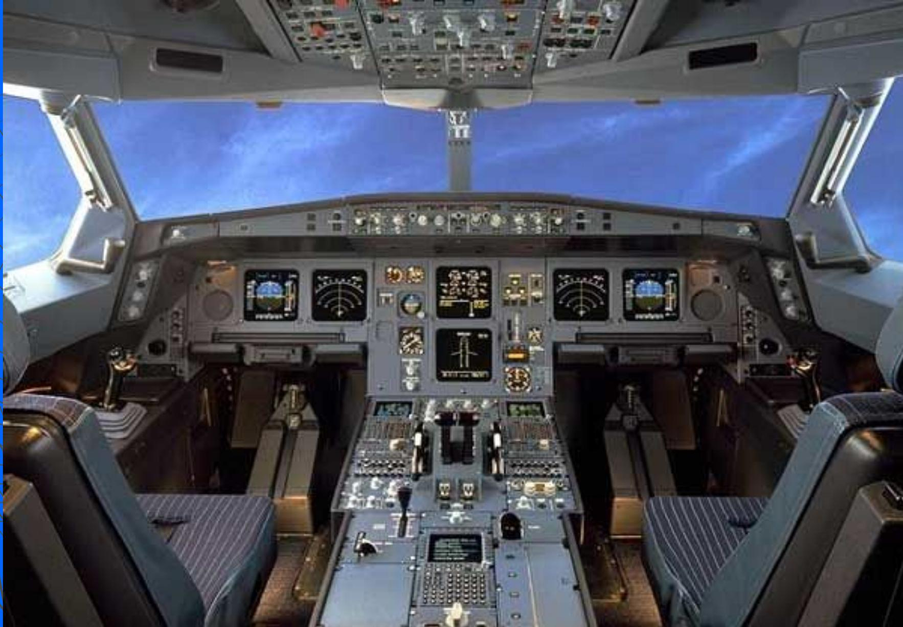
**Электроника управления А330 одинаковая с А340 и А320. Кабина управления одинаковая для А320 и А330. Кабина управления А380 и А350 сделана на основе серии А330. Благодаря этому обучение лётчиков для этих моделей происходит по схожим программам**
