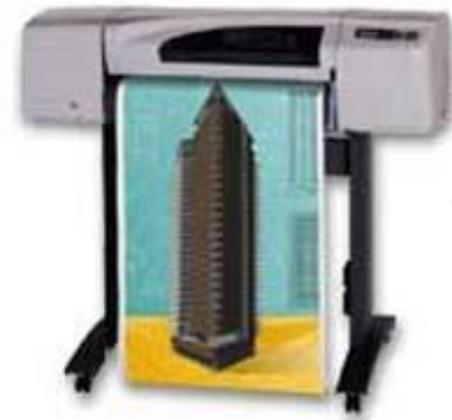
**Плоттер** (графопостроитель) – устройство для вывода на бумагу чертежей. Обычный плоттер использует листы форматом A1. Скорость печати примерно 1 лист/час.
