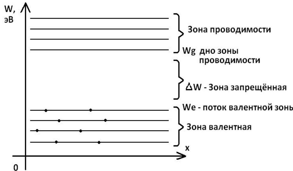
Согласно зонной теории Паули электроны атомов размещаются на уровнях, соответствующих энергий. При взаимодействии атомов между собой уровни одинаковых энергий образуют зоны: валентную, запрещенную и проводимости.
