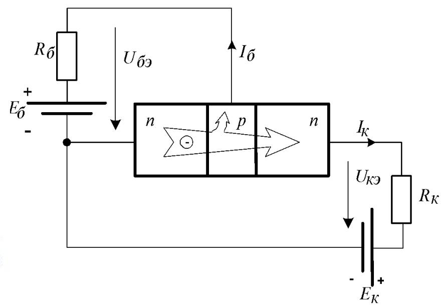
Схема включения транзистора в активном режиме работы
