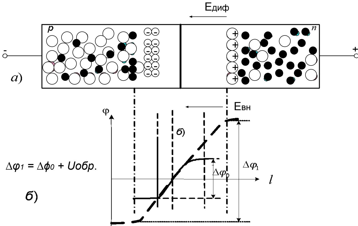
Модель P-N- перехода при обратном включении (а) и график распределения потенциала поля (б)
