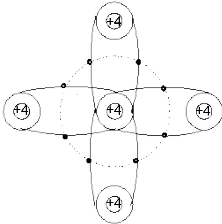
Собственные полупроводники имеют кристаллическую структуру. В такой решетке каждый атом взаимно связан с четырьмя соседними атомами ковалентными связями, в результате этой связи происходит образование устойчивых электронных оболочек, состоящих из восьми электронов.
