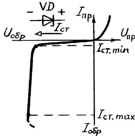
Полупроводниковый стабилитрон работает в области электрического пробоя.
