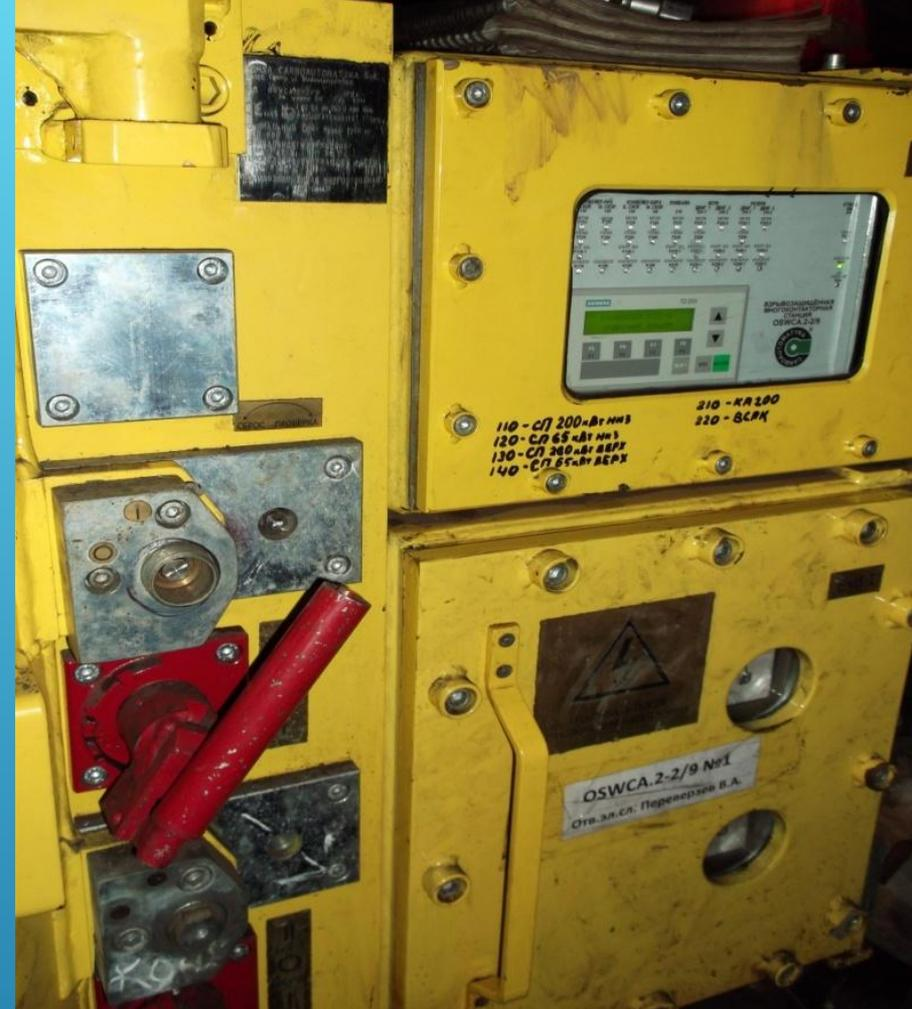
ВЗРЫВОЗАЩИЩЁННАЯ МНОГО КОНТАКТОРНАЯ СТАНЦИЯ ТИПА OSWCA 2-2/9 ЯВЛЯЕТСЯ РАСПРЕДЕЛИТЕЛЬНЫМ УСТРОЙСТВОМ, ПРЕДНАЗНАЧЕННЫМ ДЛЯ ПОДЗЕМНЫХ ШАХТ, ДЛЯ ВКЛЮЧЕНИЯ И УПРАВЛЕНИЯ ЭЛЕКТРИЧЕСКИМИ ПРИВОДАМИ ГОРНЫХ МАШИН И УСТРОЙСТВ, ПИТАЮЩИХСЯ ОТ ТРЕХФАЗНОЙ СЕТИ ПЕРЕМЕННОГО ТОКА С ИЗОЛИРОВАННОЙ НЕЙТРАЛЬЮ ТРАНСФОРМАТОРА.
