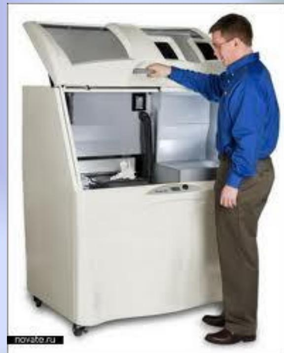
**3D-принтер** — устройство, использующее метод послойного создания физического объекта, на основе виртуальной 3D-модели
