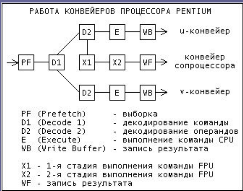
Упрощенная блок схема процессора Pentium
