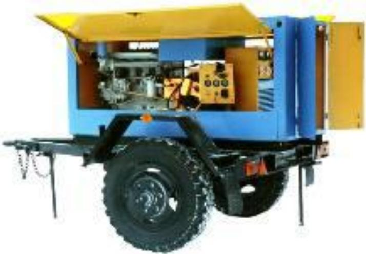
Плавное регулирование сварочного тока осуществляется за счет изменения напряжения холостого хода, для чего служит реостат  $R$  в цепи намагничивающей обмотки. Увеличение сопротивления  $R$  приводит к снижению намагничивающего тока снижению потока намагничивания  $\Phi_n$ , напряжения холостого хода генератора и, наконец, к уменьшению сварочного тока.
