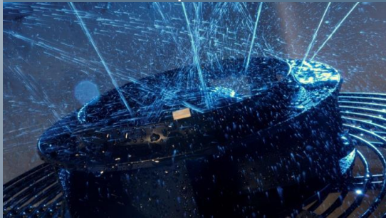
Испытательная установка с водяными брызгами
