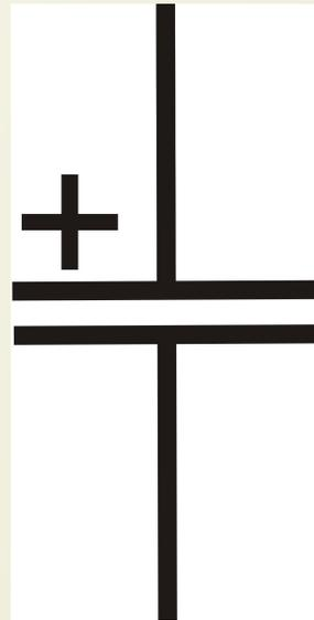
**конденсатор оксидный поляризованный
