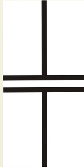
**конденсатор постоянной емкости,
