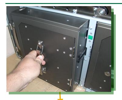
Вставьте ключ в замок запирающий выбранную кассету и поверните по часовой стрелке. Потянув за ручку выгрузите кассету из модуля.
