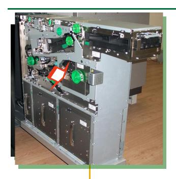
Нажмите на зелёную кнопку и потянув за ручку полностью выдвиньте модуль приема наличных из сейфа для выгрузки кассет.
