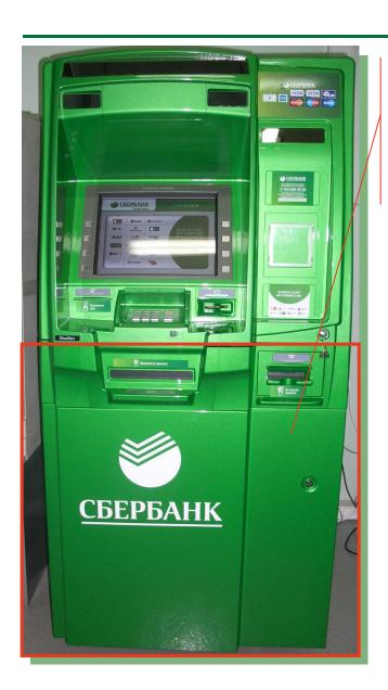
Для доступа к устройствам нижней части банкомата повернуть ключ замка по часовой стрелке и открыть фальшь-дверь лицевой панели
