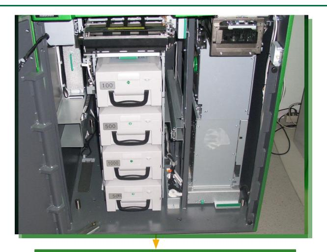
Затем поверните ручку замка по часовой стрелке и откройте дверь сейфа.
