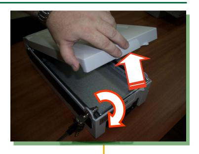
Установите кассету на горизонтальную плоскость и поверните ключ по часовой стрелке для разблокировки крышки кассеты. Затем поднимите крышку кассеты.
