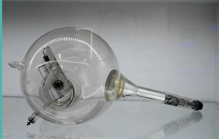
Здесь же в трубке имеется электронная пушка. Она создает электронный луч, который 25 раз в 1 секунду успевает «оббежать» мозаичный экран, считывая это изображение и создавая в электрической цепи ток, называемый сигналом изображения.
