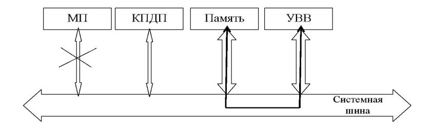
**При ПДП** требуется введение в систему дополнительного устройства – **контроллера ПДП**, которое будет осуществлять полноценный обмен по системной шине, без участия МП. Причем МП предварительно сообщает контроллеру ПДП откуда ему следует брать и куда помещать информацию.
