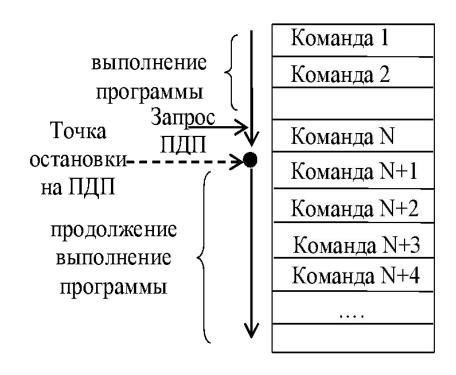
Это режим, при котором обмен информацией по системной шине идет без участия МП. ВУ требующие обслуживания сигнализирует МП, что режим ПДП необходим. В ответ на это МП заканчивает выполнение текущей команды и отключается от внешних шин. После это он сигнализирует запросившему устройству, что обмен в режиме ПДП можно начинать.
