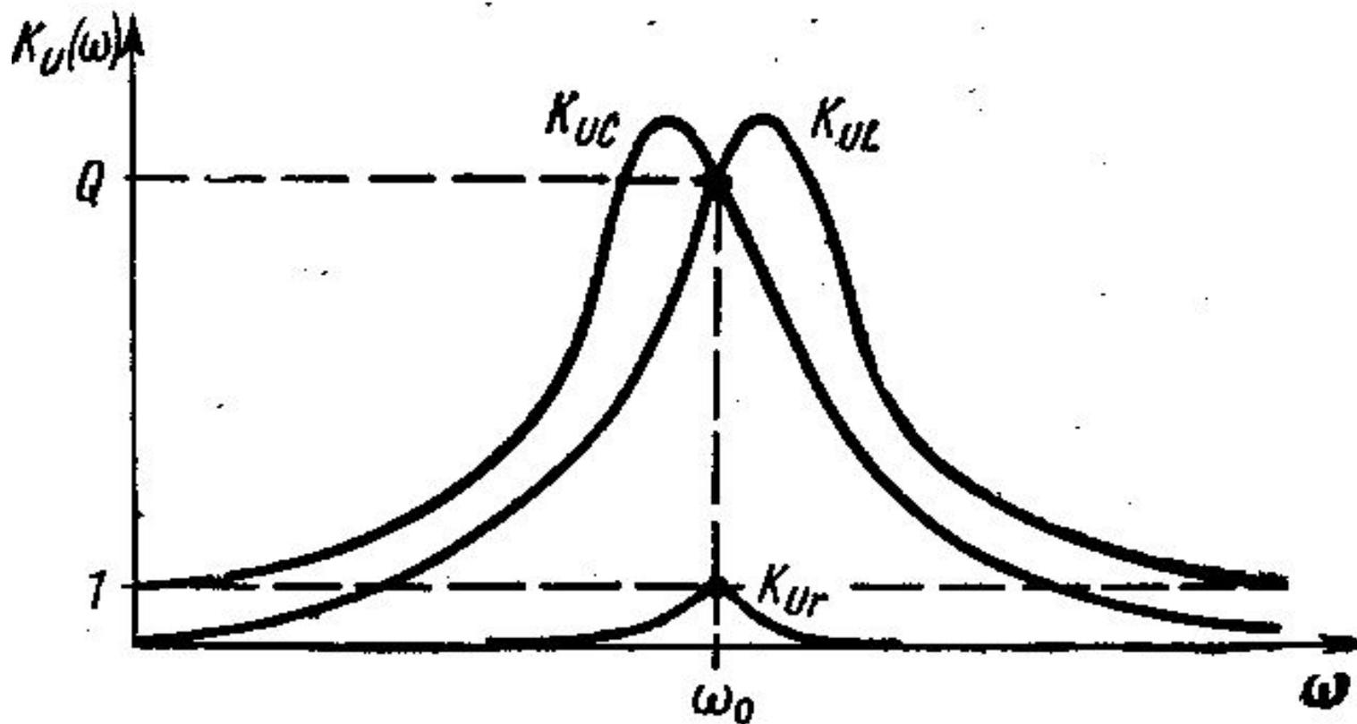
Численно передаточные функции, или коэффициенты передачи по напряжению, показывают, во сколько раз напряжение на соответствующем элементе больше напряжения, действующего на входе контура. Из полученных соотношений, в частности, следует, что при резонансе напряжения на реактивных элементах в  $Q$  раз превышают входное напряжение, а напряжение на активном элементе равно ему.
