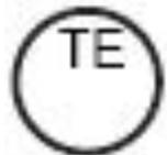
Первичный измерительный преобразователь для измерения температуры, установленный по месту.
