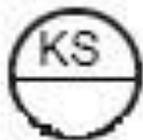
Прибор для управления процессом по временной программе, установленный на щите.
