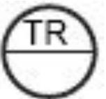
Прибор для измерения температуры одноточечный, регистрирующий, установленный на щите.
