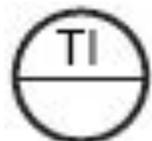
Прибор для измерения температуры показывающий, установленный на щите.
