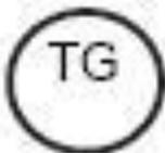
Прибор для измерения температуры показывающий, установленный по месту.
