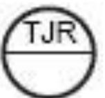
Прибор для измерения температуры с автоматическим обегющим устройством, регистрирующий, установленный на щите.
