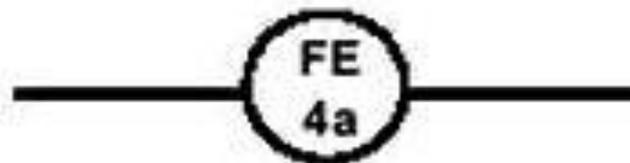
Условное графическое обозначение приборов, устанавливаемых на технологическом оборудовании
