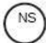
Пусковая аппаратура для управления электродвигателем (включение, выключение насоса; открытие, закрытие задвижки и т. д.).
