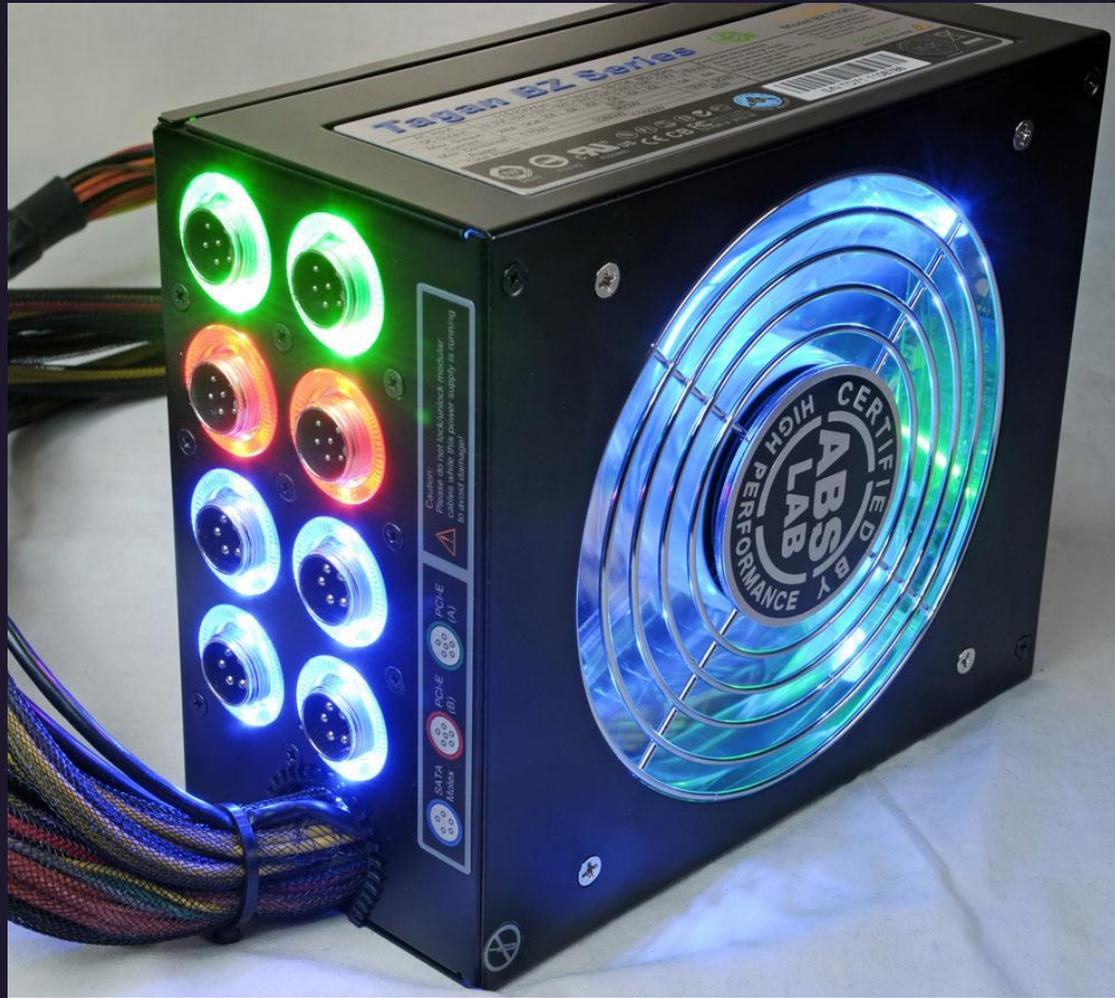
**Компьютерный блок питания (БП)** — источник электропитания, предназначенный для снабжения узлов компьютера электроэнергией постоянного тока путём преобразования сетевого напряжения до требуемых значений.
