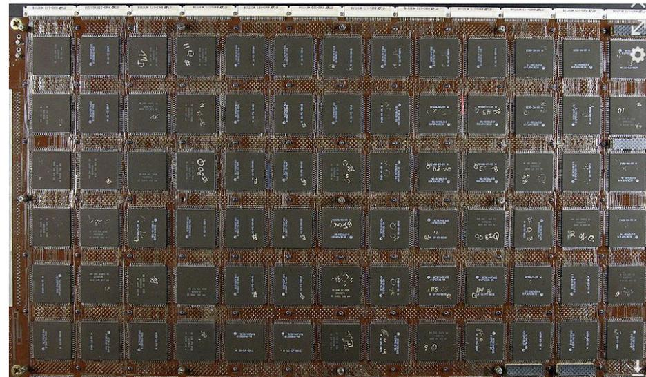
Процессорная плата векторного компьютера Cray YMP
